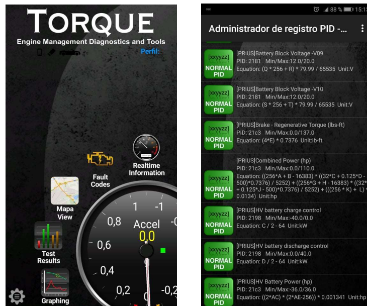
Figura 3.14 Aplicación móvil Torque y algunas de las variables que permite monitorizar
