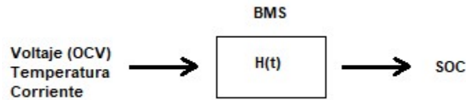
Figura 2.13 Sistema LTI para los métodos de estimación basado en datos experimentales.
