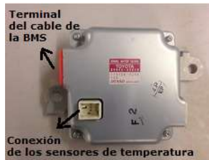
Figura 4.9 Terminal de lectura de la BMS o sensor de voltaje
