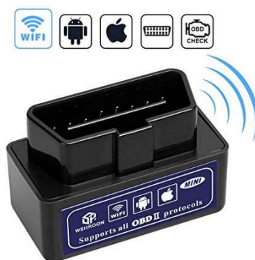
Figura 3.13 Conector de Diagnostico OBD2 (Wsiiroon Car WiFi OBD2) usado en las mediciones
