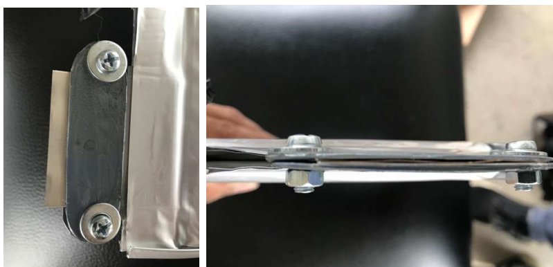
Figura 4.4 Estructura para la unión de dos celdas en serie
