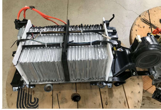
Figura 4.11 Banco de baterías nuevo junto con todos los componentes
