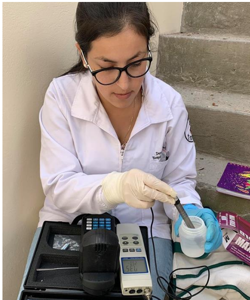
Colocación del electrodo en la muestra de estudio.
