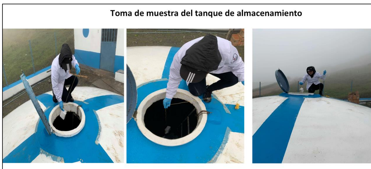
Fotografía 9. Procedimiento de muestreo en el tanque de almacenamiento.
