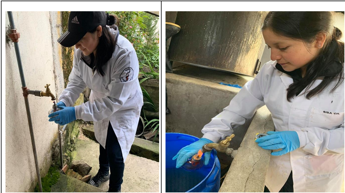
Desinfección de los grifos con el mechero de alcohol durante 30 segundos.
