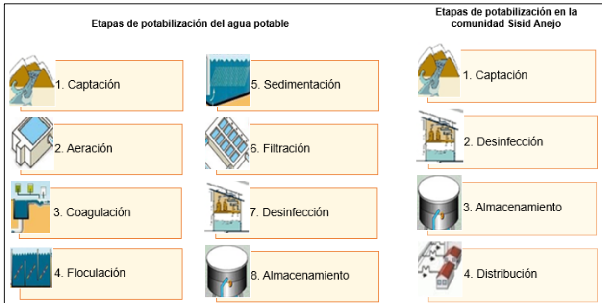
Figura 4. Etapas de potabilización del agua cruda.
