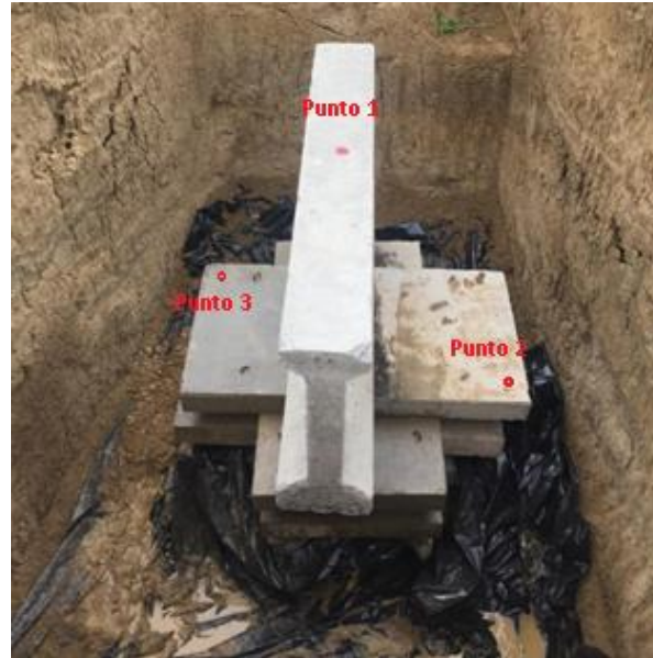
Figura 25. Ensayo de consolidación campo.
