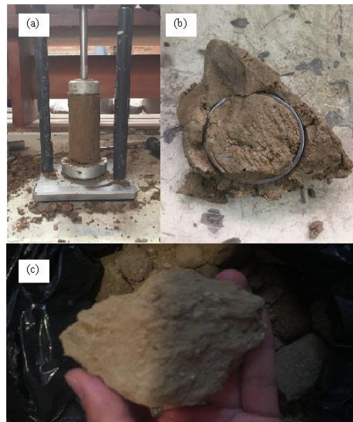
Figura 16. (a) Muestra tallada. (b) Muestra obtenida por anillo. (c) Muestra sin geometría definida.
