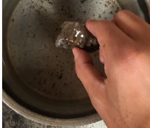
Figura 17. Muestra impermeabilizada con parafina.
