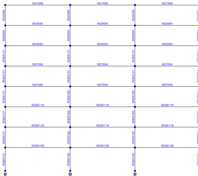
Figura 4.36: Secciones de acero ocupadas en el Edificio
