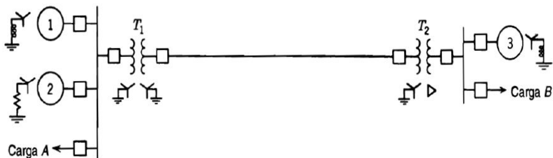
Figura 2.2. Diagrama unifilar de un sistema eléctrico de potencia. [7]
