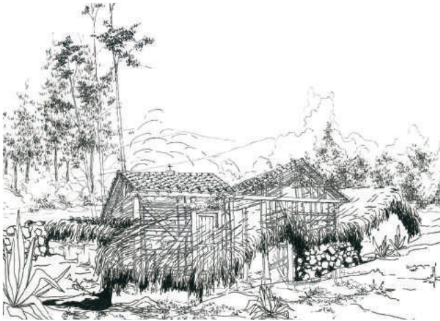
Imagen 33. Edificación con cubierta con revestimiento de teja y paja.
