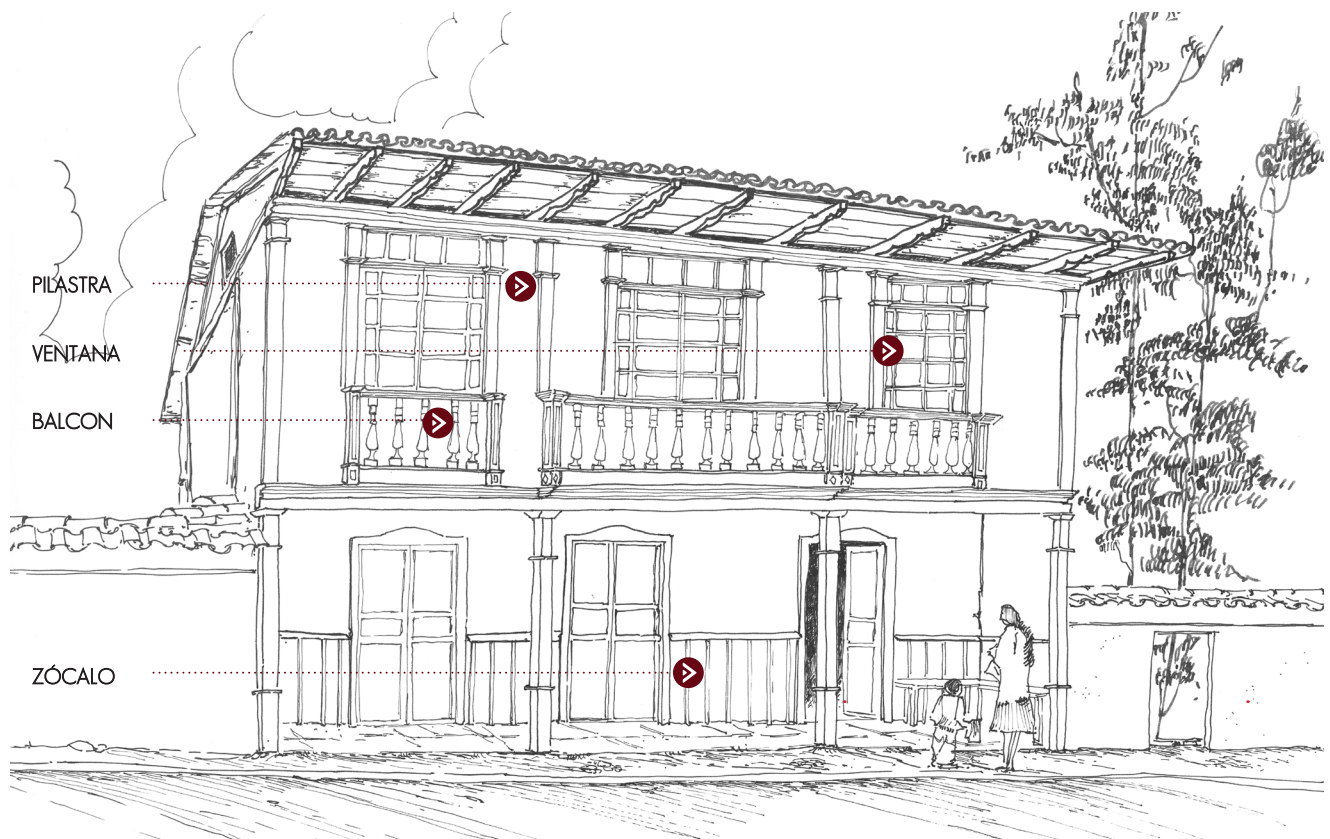
Imagen 51. Edificación con zócalos de madera.
