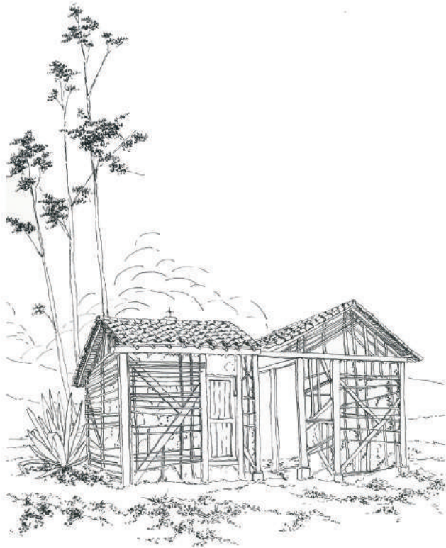
Imagen 25. Estructura para conformar muros de bahareque.
