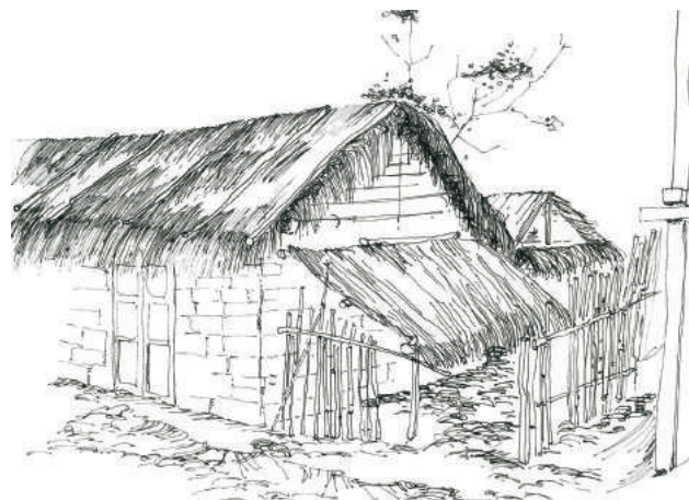
Imagen 83. Cerramiento en tiras de madera.
