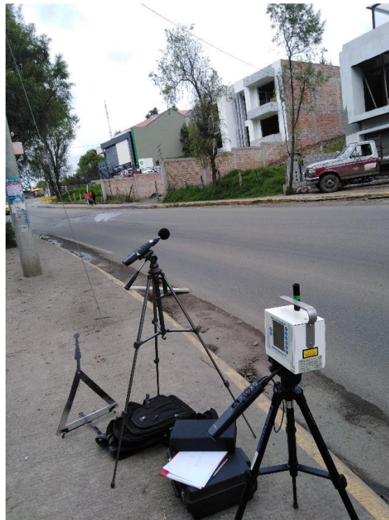
Fotografía 4. Monitoreo de Nivel de presión Sonora y Material Particulado (PM10 y PM2,5). Ubicación: PG1. Periodo: Junio-Julio del 2019. Horario: 06:30 a 07:30. Fuente: Autor
