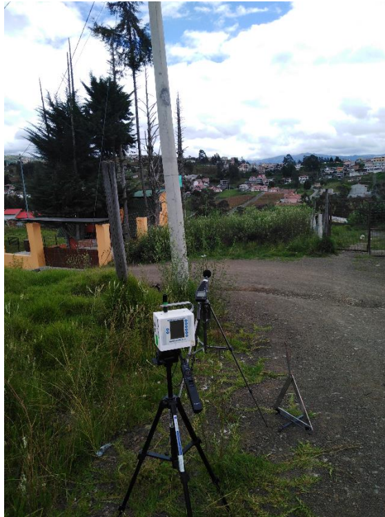
Fotografía 5. Monitoreo de Nivel de presión Sonora y Material Particulado (PM10 y PM2,5). Ubicación: PG3. Periodo: Junio-Julio del 2019. Horario: 12:30 a 13:30.
