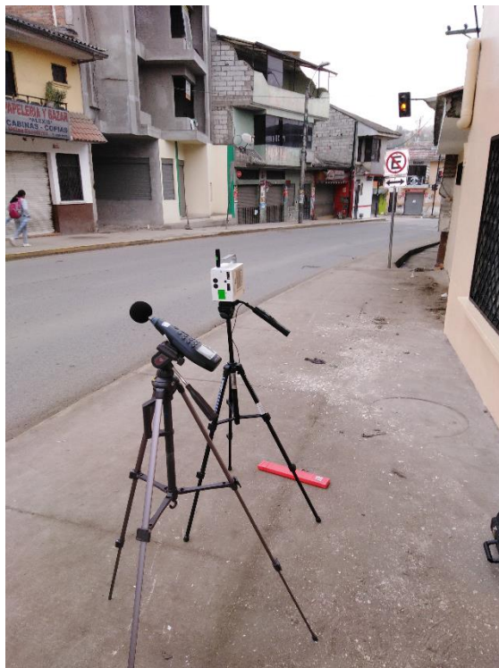
Fotografía 6. Monitoreo de Nivel de presión Sonora y Material Particulado (PM10 y PM2,5). Ubicación: PG6. Periodo: Junio-Julio del 2019. Horario: 06:30 a 07:30.
