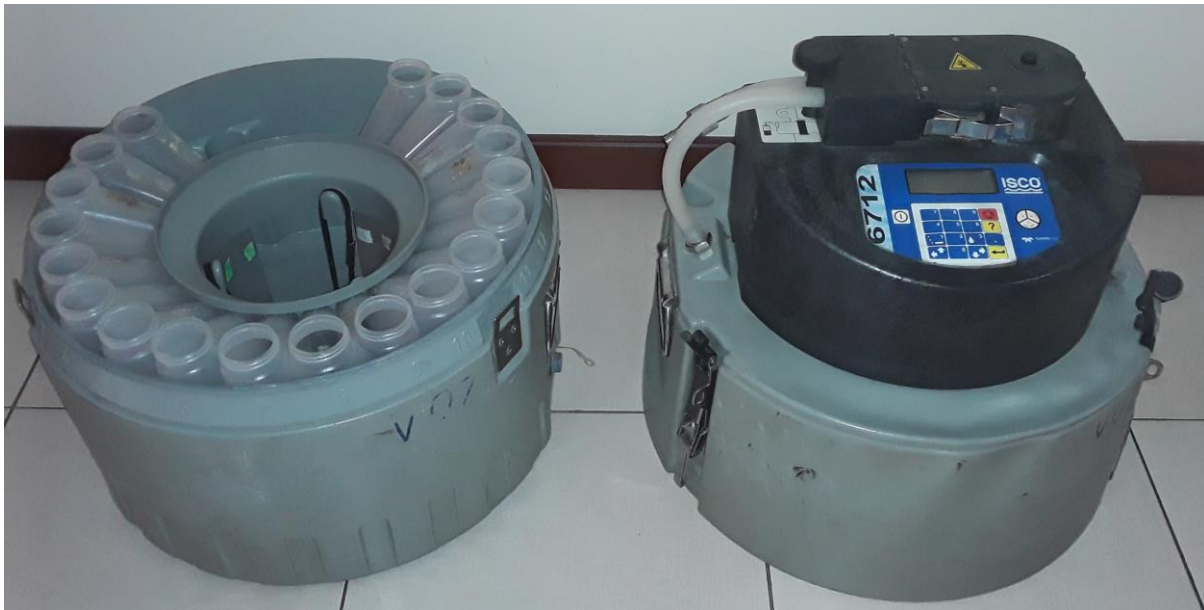
Figura 2.3 Sonda de muestreo ISCO 6712 Elaboración: Autor
