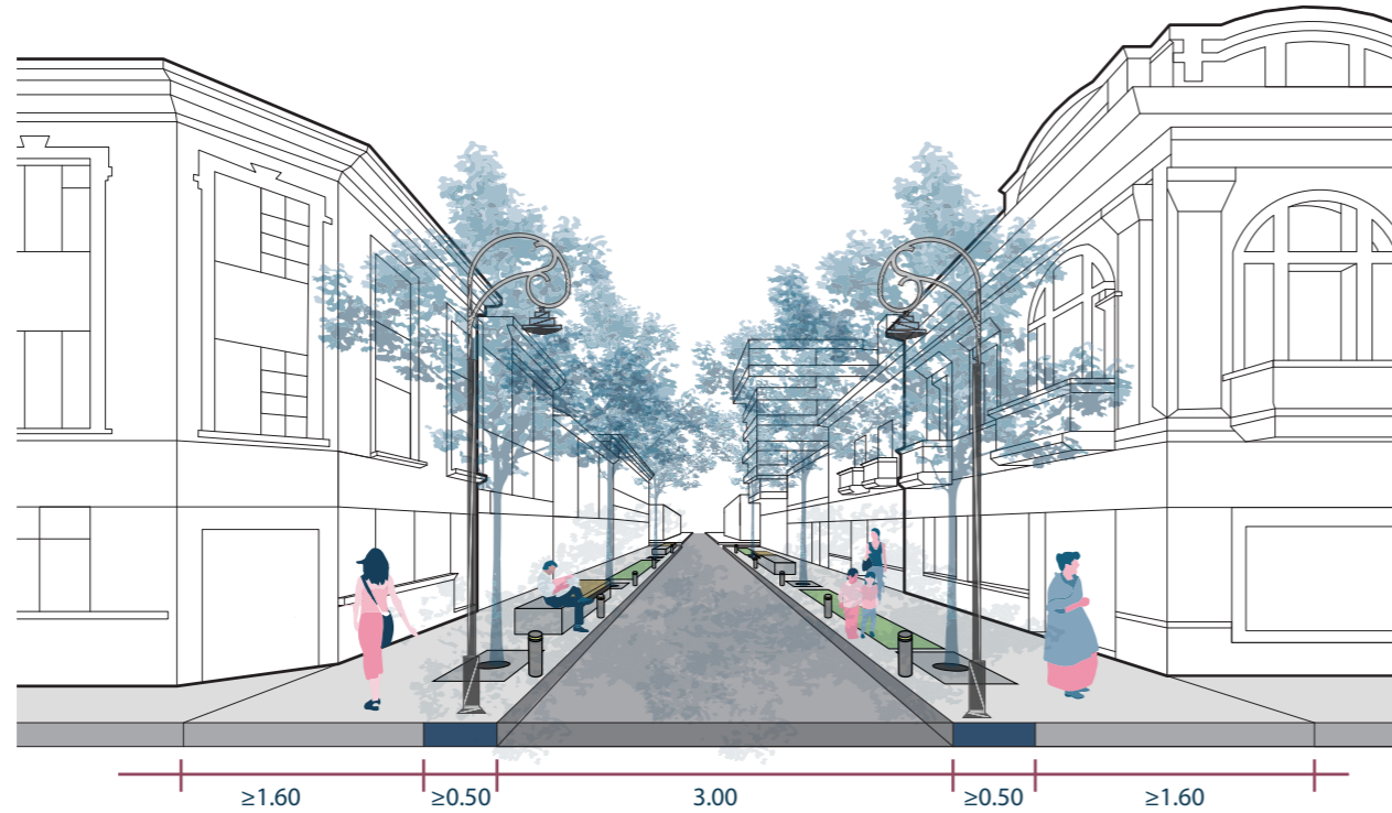
Figura 4.06: Esquema de tramo vial tipología B.
