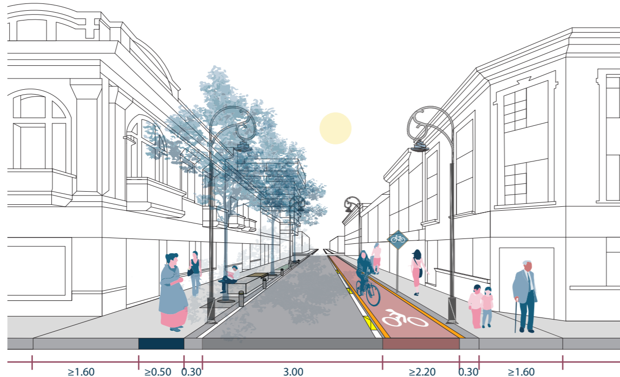
Figura 4.10: Esquema tramo vial tipología D.
