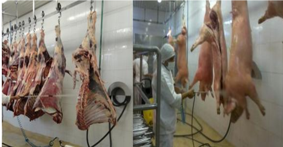
Figura 5: Lavado y desinfección de canales de res y cerdo ( Fuente: Empresa ITALIMENTOS)
