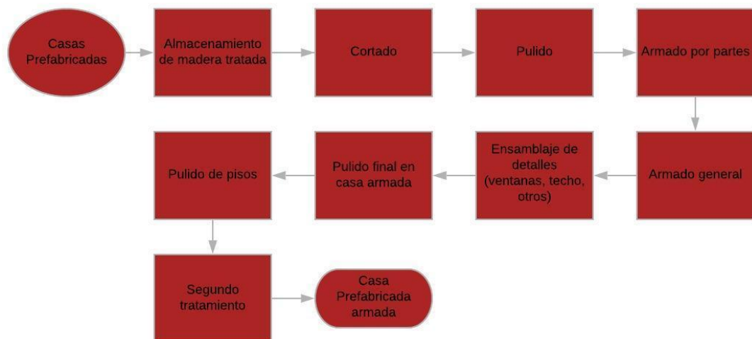
Figura 6. Diagrama del proceso de construcción de casas prefabricadas.
