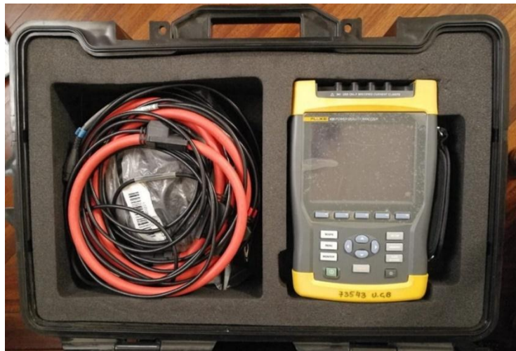
Figura 4.1 Equipo de medición FLUKE 435 utilizado.
