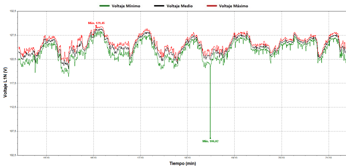
Figura 4.40 Valores máximos, medios y mínimos del voltaje en la L1N.
