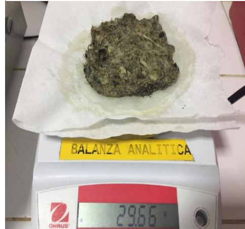
Ilustración 7 Pesado del material retenido en el filtro
