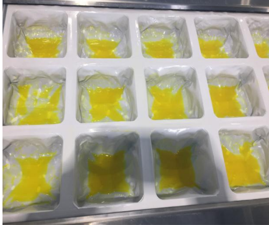
Ilustración 9 Solución colorante colocada en la máquina envasadora
