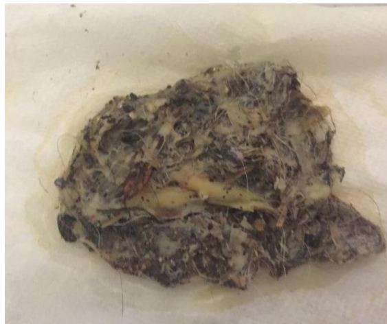
Ilustración 7 Material retenido en el filtro
