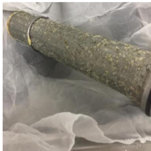
Ilustración 5 Filtro después del segundo ensayo de validación
