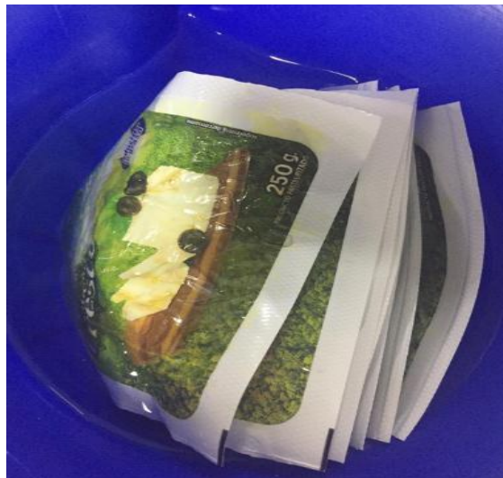
Ilustración 11 Inmersión en agua de los empaques con solución colorante
