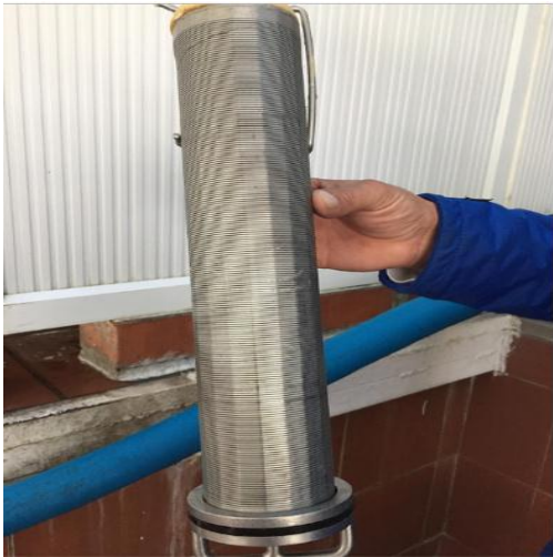
Ilustración 4 Filtro después del primer ensayo de validación
