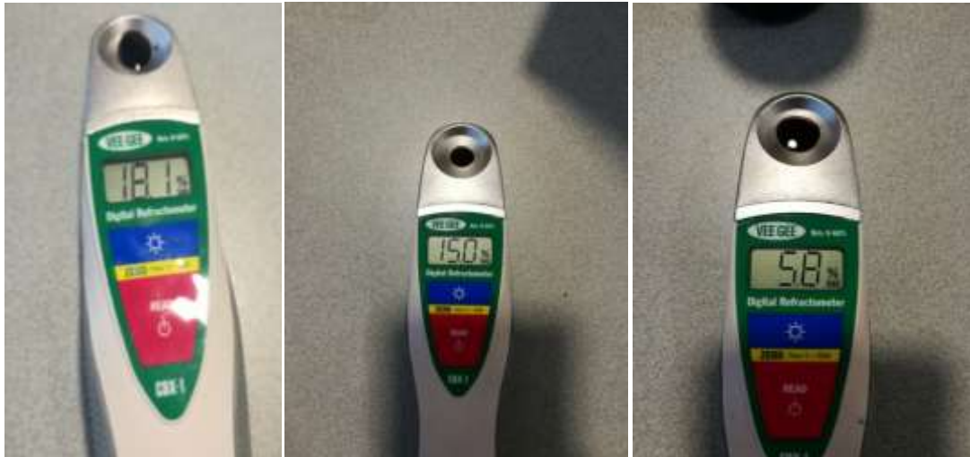
Ilustración 35. Medición de los grados Brix en mosto, pulpa y vino de motilón, respectivamente, en la obtención del vino de motilón, como base del cálculo para el contenido de alcohol.
