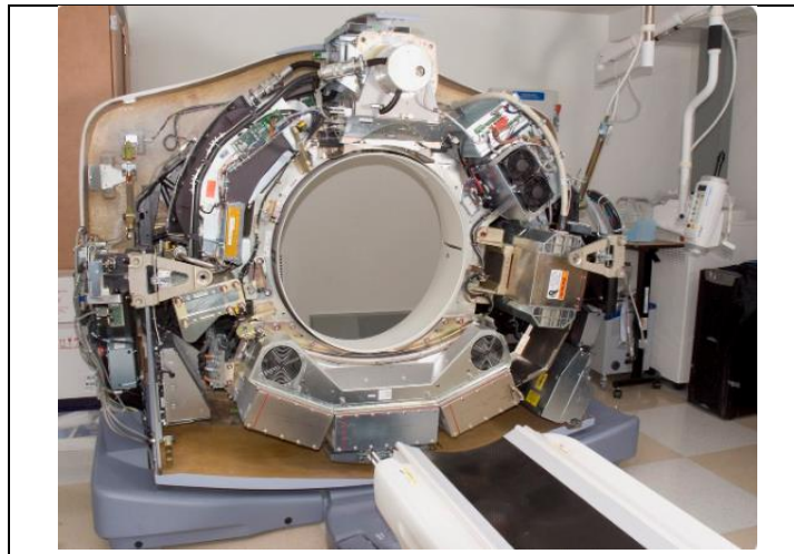
Figura 9. Partes internas de un Tomógrafo de 64 cortes. Fuente: https://twitter.com/hashtag/NationalTechnologyDay?sr
