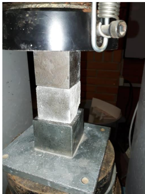
Ilustración 8. Ensayo de resistencia para morteros.
