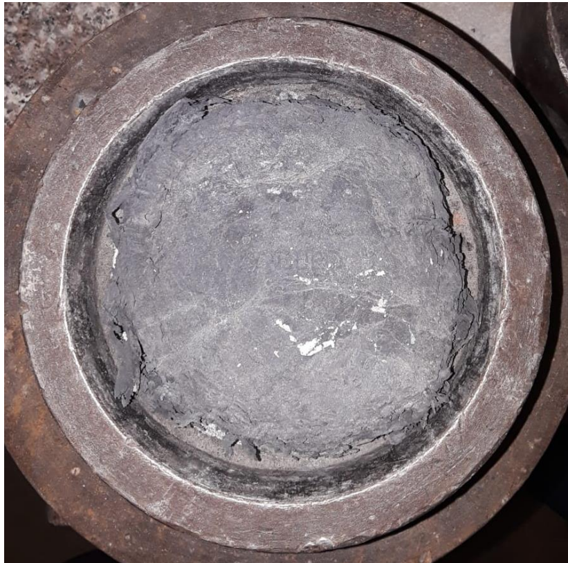
Ilustración 27. Área de aplicación de carga por neopreno.
