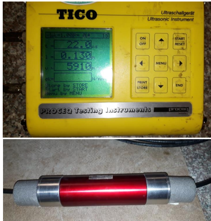
Ilustración 39. Verificación de la calibración del equipo.
