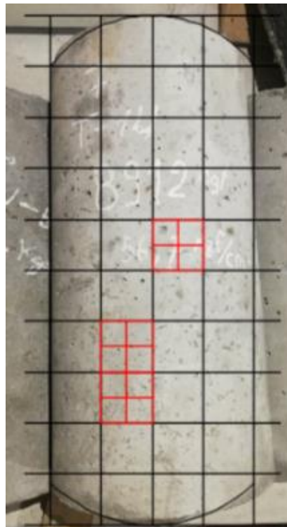
Ilustración 53. Sectorización del hormigón de 7% humo de sílice.
