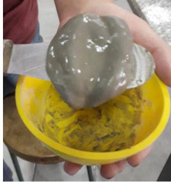
Ilustración 5. Pasta homogénea para determinar la compacidad del cemento.
