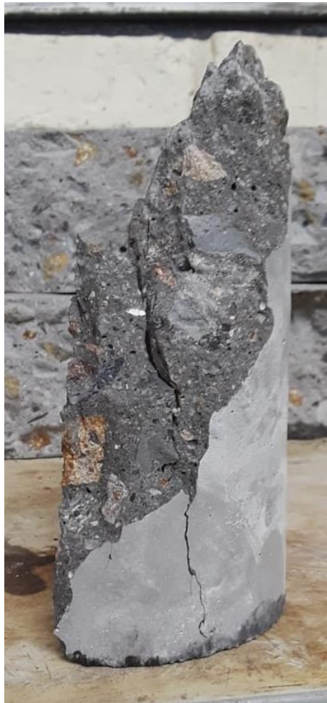
Ilustración 32. Tipo de falla 3.
