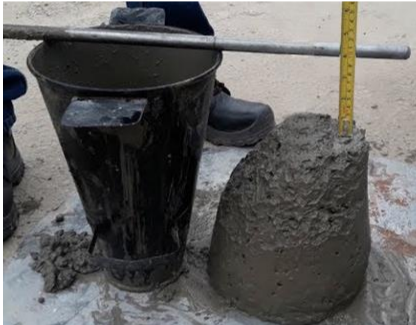
Ilustración 22. Revenimiento del hormigón.
