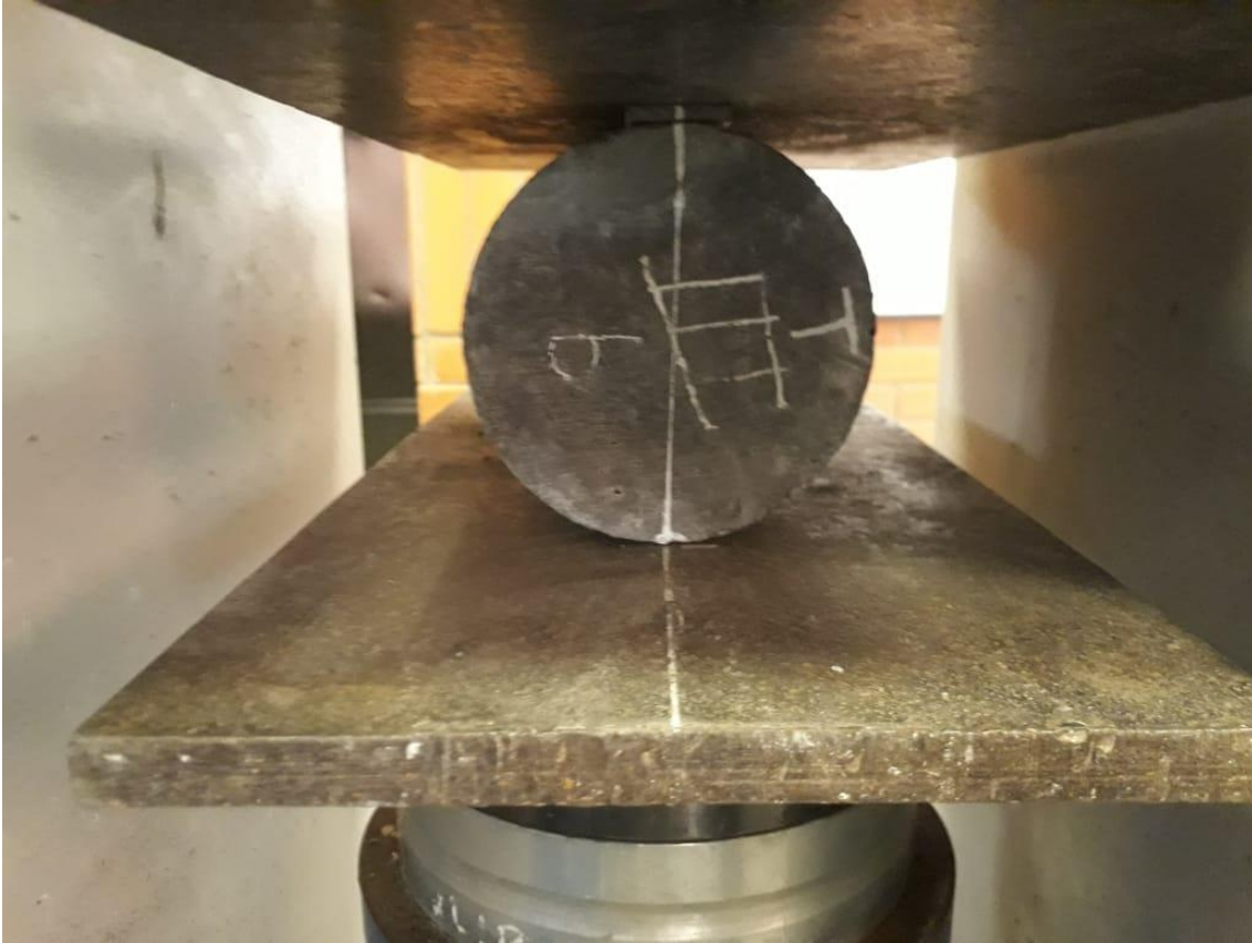
Ilustración 35. Ensayo de tracción para cilindros.
