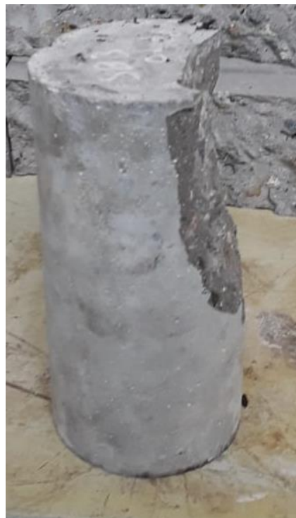
Ilustración 33. Tipo de falla 5.
