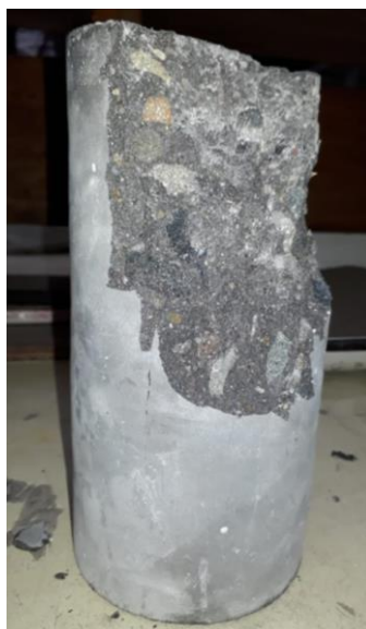
Ilustración 66. Tipo de falla 2-1 en probetas de hormigón.
