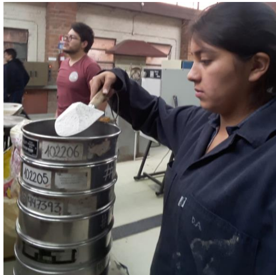
Ilustración 3. Separación en tamices del agregado.
