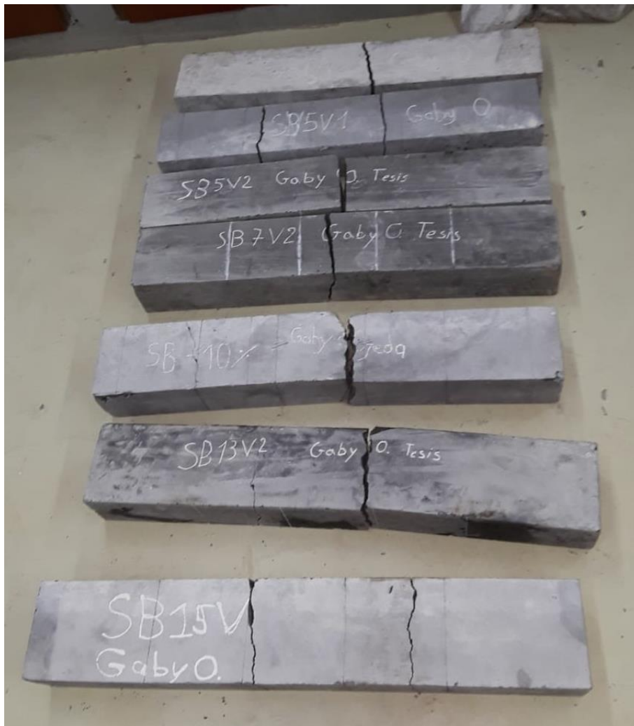
Ilustración 38. Probetas ensayadas a flexión.
