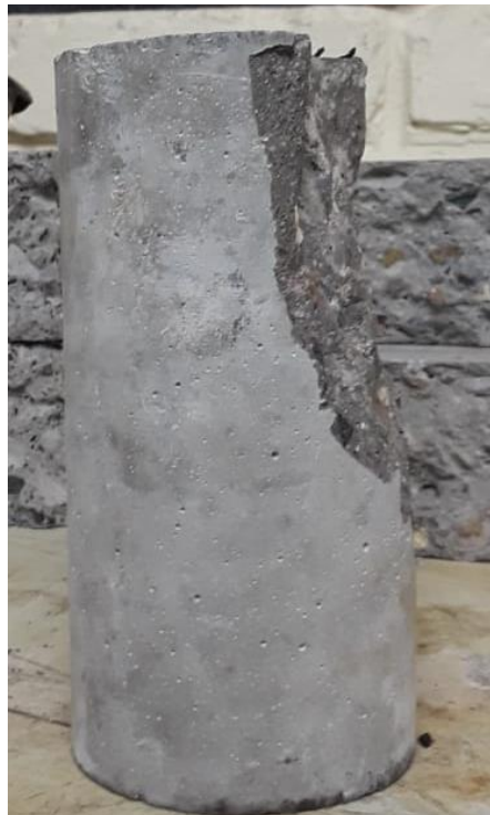
Ilustración 31. Tipo de falla 2-2.
