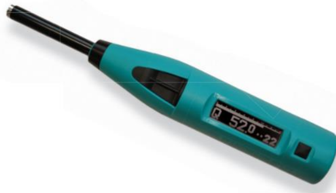
Ilustración 42. Equipo utilizado para el ensayo.
