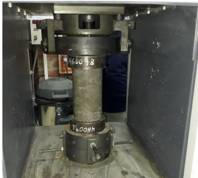
Ilustración 28. Ensayo de compresión para cilindros.
