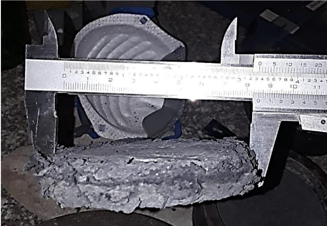
Ilustración 26. Medida del neopreno desgastado.
