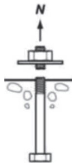
Figura 79: Falla del acero, ACI 318.
