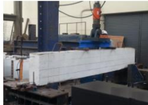
Figura 2-14. Aplicación de sensores de desplazamiento LVDT Fuente: (Bazán Jorge, 2015)
