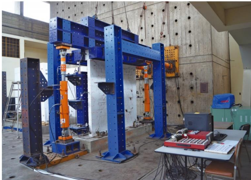
Figura 2-6. Sistema de aplicación de carga. Fuente: (CISMID)
