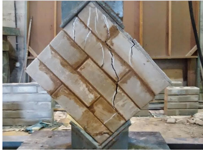
Figura 3-5. Resistencia a la compresión diagonal. Fuente: (Ladrillos Ecológicos El Bajo, 2015)
