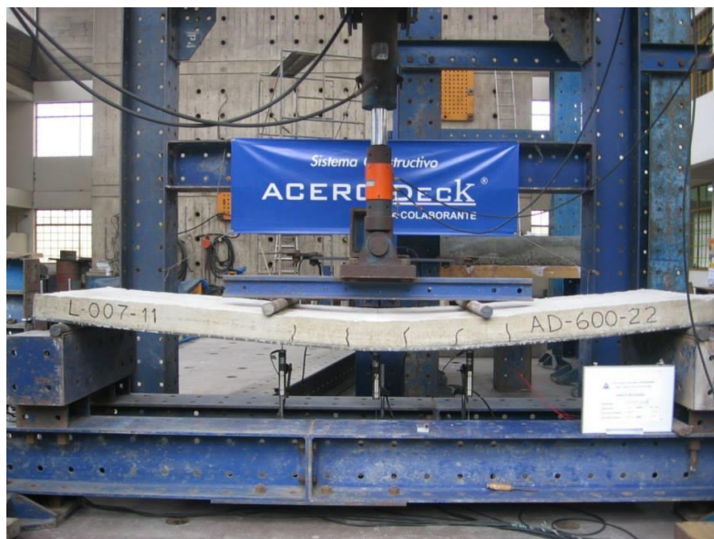
Figura 2-7. Ensayo a flexión de losa de hormigón. Fuente: (CISMID)
