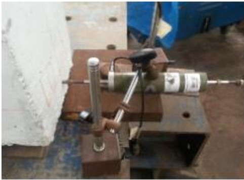
Figura 2-14. Aplicación de sensores de desplazamiento LVDT Fuente: (Bazán Jorge, 2015)
