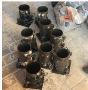
Figura 27. Cilindros, previo al vaciado de hormigón
