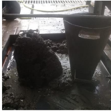
Figura 26. Medición de asentamiento
