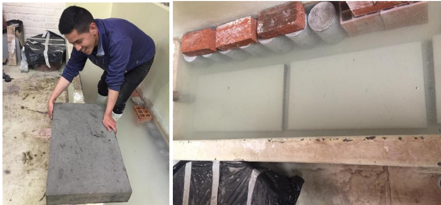
Figura 36. Proceso de curado del hormigón
