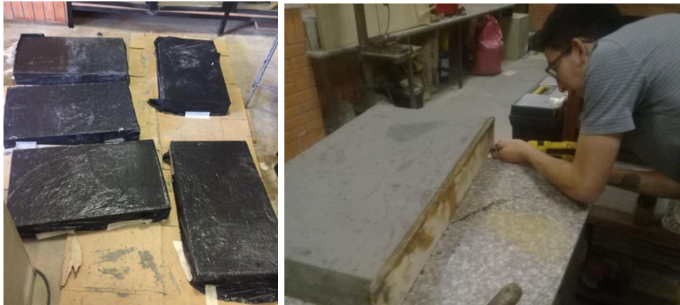
Figura 35. Fraguado inicial y desencofrado de los paneles
