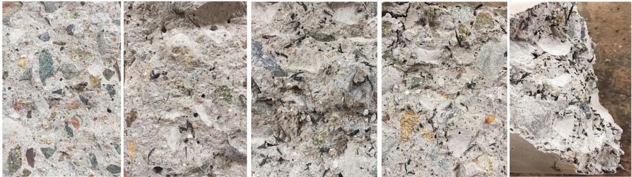
De izquierda a derecha, hormigón patrón (0%), 5%, 22%, 30% y 40% de inclusión de caucho en reemplazo de volumen de árido fino. Figura 48. Porosidad en especímenes de hormigón
