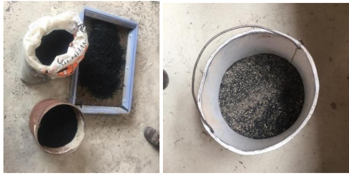
Figura 24. Obtención y mezcla del caucho con el agregado fino
