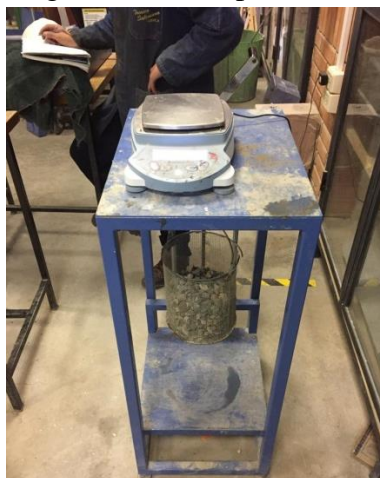
Figura 19. Determinación de la densidad, árido grueso
