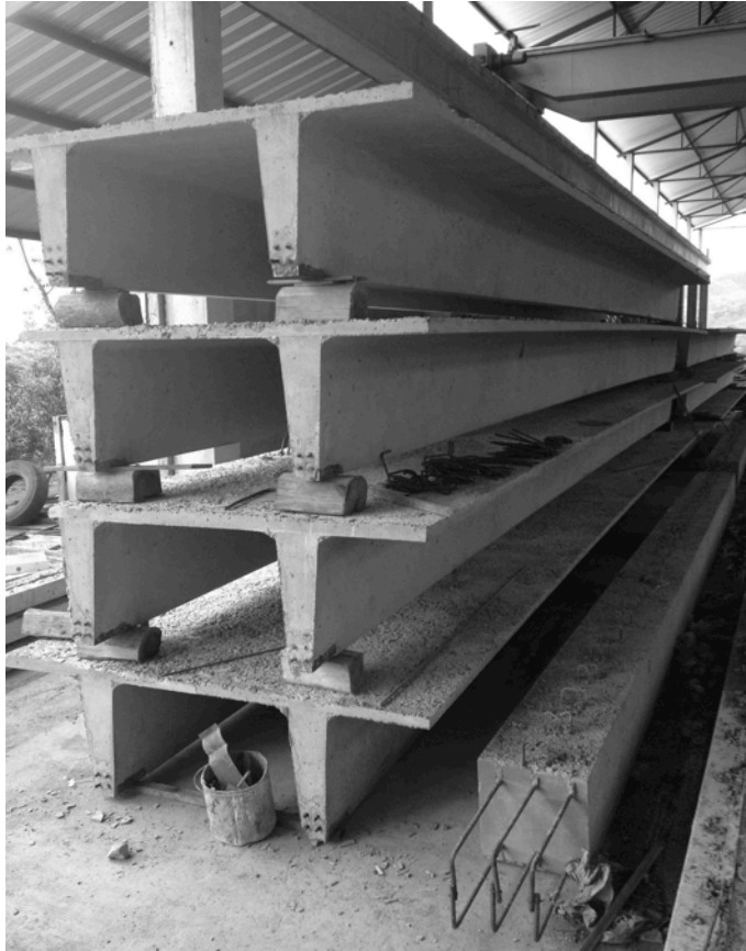
Losas doble T apiladas, listas para transportar. A la izquierda inferior, vigas de amarre para cimentaciones. Planta RFV Cuenca.
