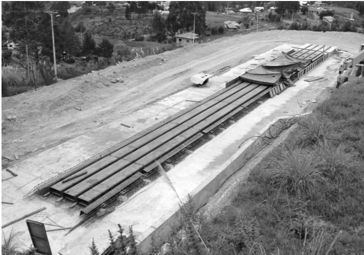
Encofrados fijos o "camas", usados para la producción de elementos pretensados de la Compañía RFV. Cuenca
