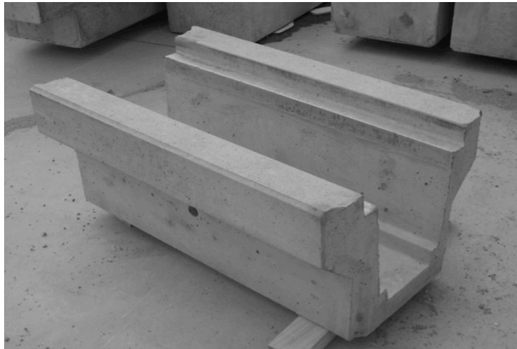
La sección de un elemento prefabricado puede solucionar al mismo tiempo diferentes temas proyectuales: estructura, estética y evacuación de aguas
