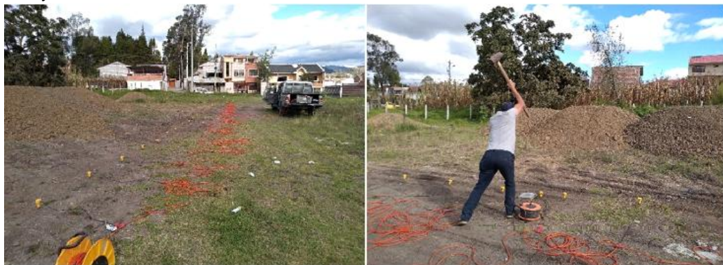
Figura 3.15 Tendido, cableado y registro de datos de la línea MASW. Fuente: Propia
