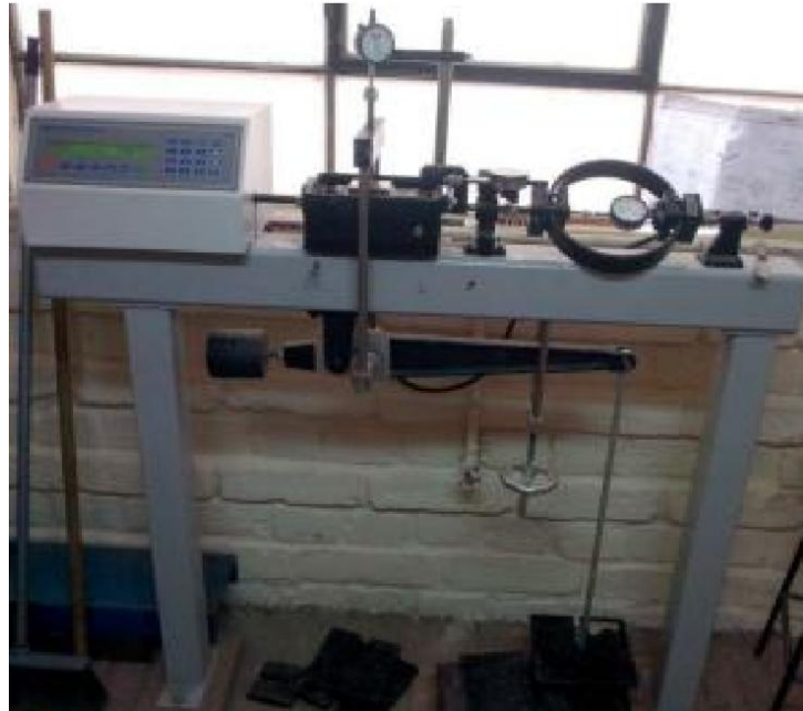
Figura 3.7 Máquina de corte directo perteneciente a la Universidad de Cuenca. Fuente: Propia.
