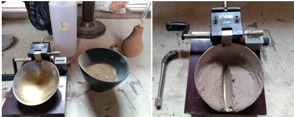
Figura 3.5 Procedimiento realizado para obtener el límite líquido. Fuente: Propia
