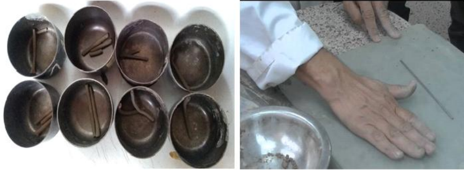
Figura 3.6 Procedimiento realizado para obtener el límite plástico. Fuente: Propia.
