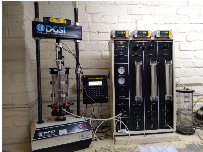
Figura 3.10 Cámara de compresión triaxial, Universidad de Cuenca. Fuente: Propia.
