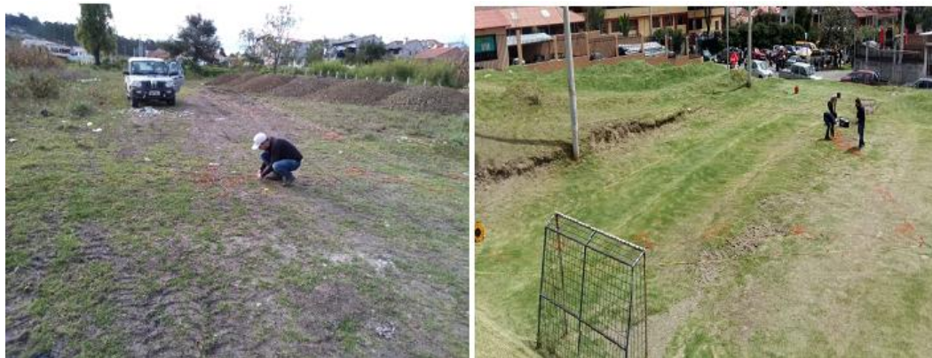
Figura 3.17 Tendido, cableado y registro de datos de la línea ESAC. Fuente: Propia
