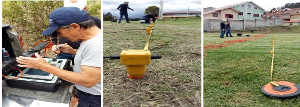
Figura 3.16 Tendido, cableado y registro de datos de la línea REMI. Fuente: Propia
