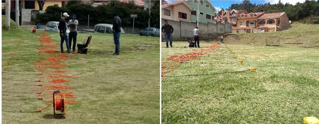
Figura 3.14 Colocación de los geófonos y registro de la línea sísmica LM1. Fuente: Propia.
