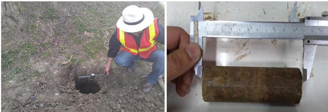
Figura 3.11 Obtención de las muestras para los ensayos de compresión triaxial. Fuente: Propia.
