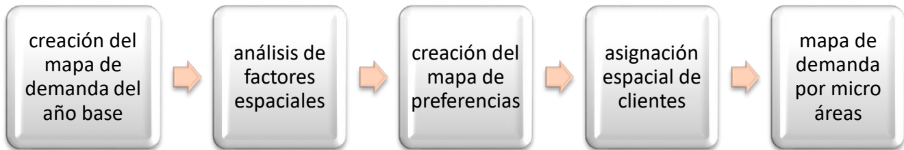
Figura 2-5: Procedimiento para la proyección de demanda eléctrica mediante análisis de micro-áreas [4]
