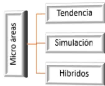
Figura 2-4: Clasificación de los métodos de proyección de demanda eléctrica mediante análisis de micro áreas [4]
