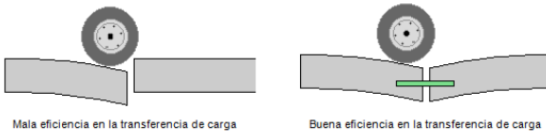
Figura 2.9. Eficiencia en la transferencia de cargas (AASHTO, 1993).
