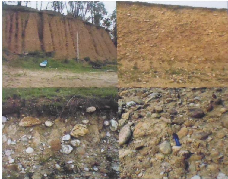
Figura 3-7: Afloramiento de grava arenosa semiconsolidada en el respaldo de la urbanización Los Trigales Altos (Tecnosuelos, 2006).
