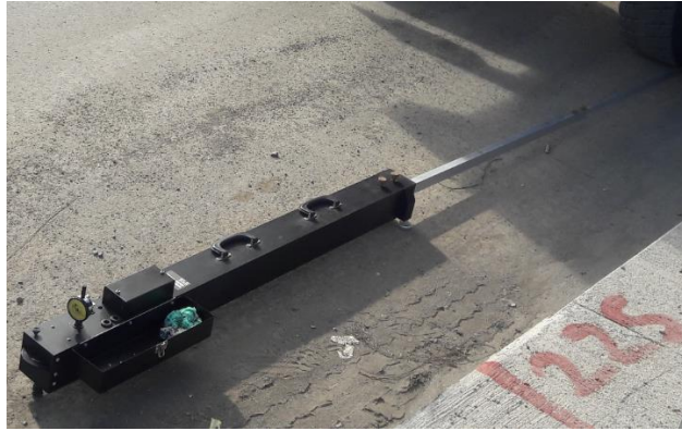
Figura 3.3 Viga Benkelman ELE 47-1460.
