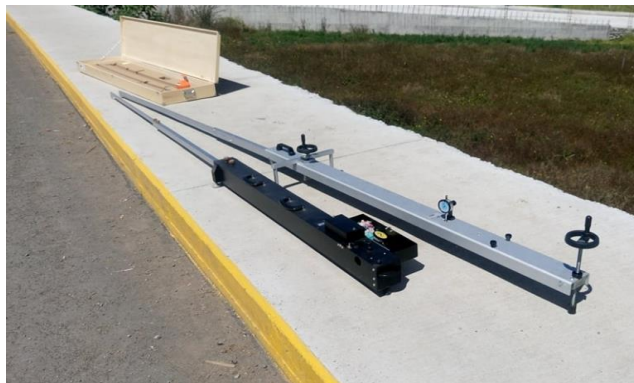
Figura 2.7 Viga Benkelman (A la izquierda equipo del Municipio de Azogues, y a la derecha equipo de la prefectura del Azuay).
