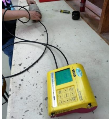
Figura 22: Ensayo de ultrasonido aplicado a espécimen tipo cilindro.
