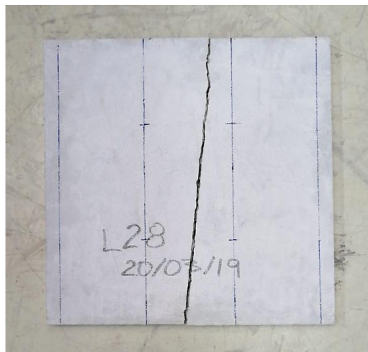
Figura 30: Tipo de falla en losas.
