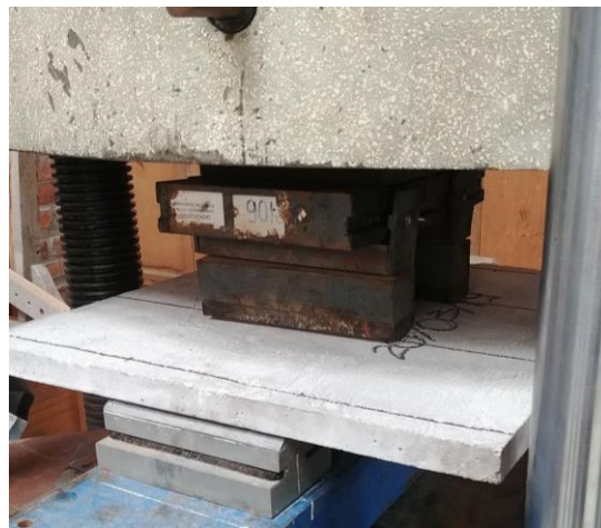
Figura 28: Ensayo a flexión en espécimen tipo losa.
