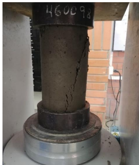
Figura 25: Especímen sometido a ensayo de resistencia a compresión.
