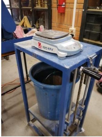
Figura 9: Determinación de densidad y absorción en árido grueso.
