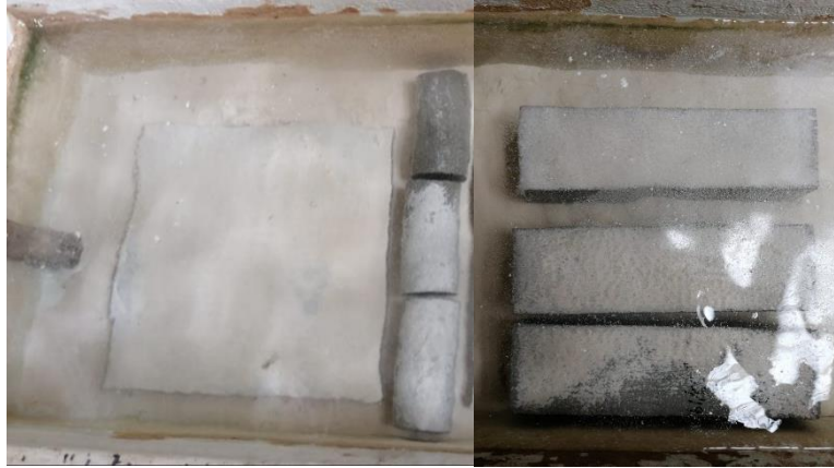
Figura 13: Curado de elementos en laboratorio (sumersión en agua con hidróxido de calcio).
