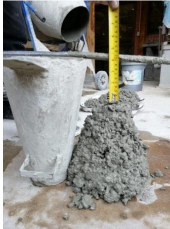
Figura 12: Determinación de asentamiento de la mezcla de hormigón (Trabajabilidad).
