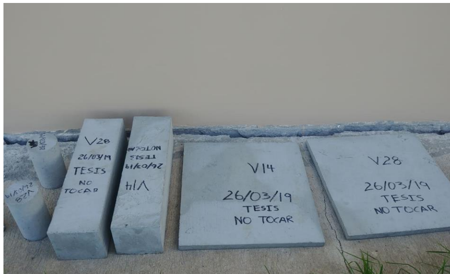
Figura 16: Curado de elementos con exposición al viento de la zona.
