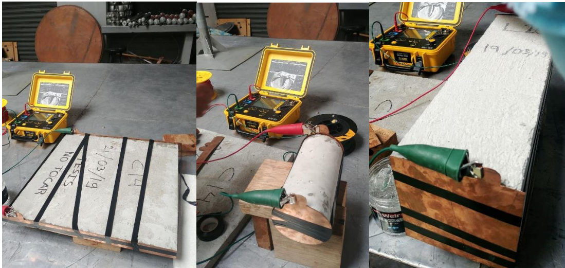
Figura 24: Ensayo de resistividad eléctrica en especímenes.
