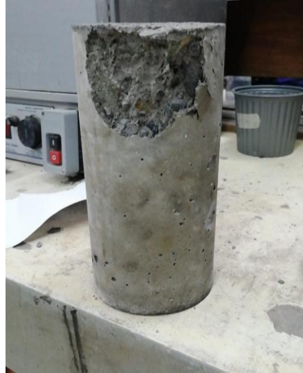
Figura 26: Tipo de falla en cilindros.
