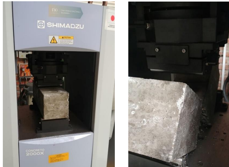
Figura 27: Ensayo a flexión en espécimen tipo viga.
