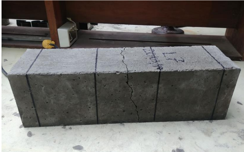
Figura 29: Tipo de falla en vigas.
