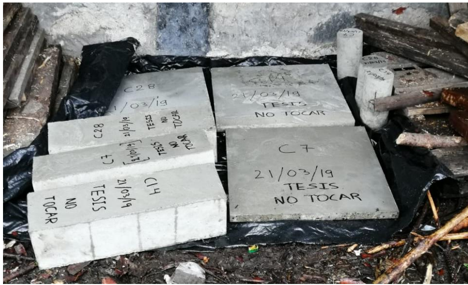
Figura 17: Curado de elementos con exposición a bajas temperaturas.
