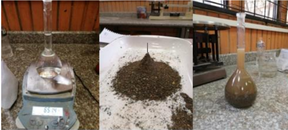
Figura 10: Determinación de densidad y absorción en árido fino.
