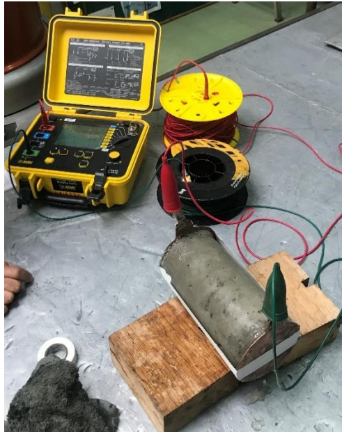
Ilustración 15. Ensayo de Resistividad Eléctrica.
