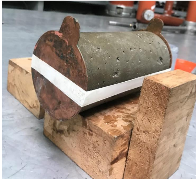
Ilustración 14. Probeta cilíndrica de hormigón con placas de cobre.
