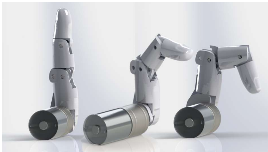
Figura 3.1.1. Prototipo robótico para replicar la motricidad del dedo índice de la mano humana
