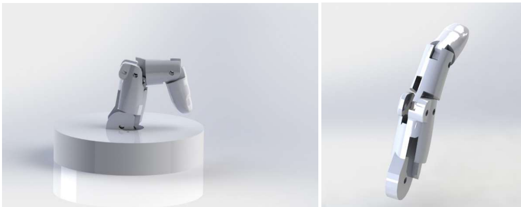
Figura 3.1.2. Prototipo robótico para replicar la motricidad del dedo índice de la mano humana
