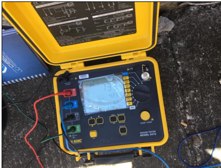
Figura 3. 5. Valor de resistividad obtenido mediante medición
