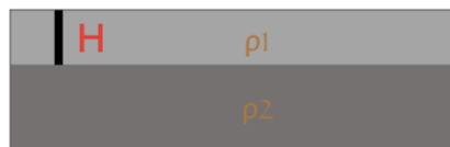
Figura 1. 2. Modelo de suelo de dos capas
