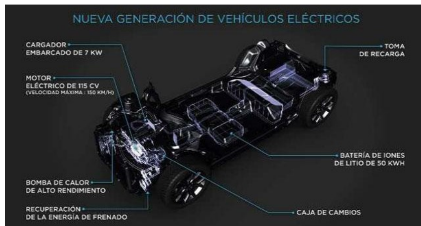
Figura 2.1: Partes principales de un vehículo eléctrico
