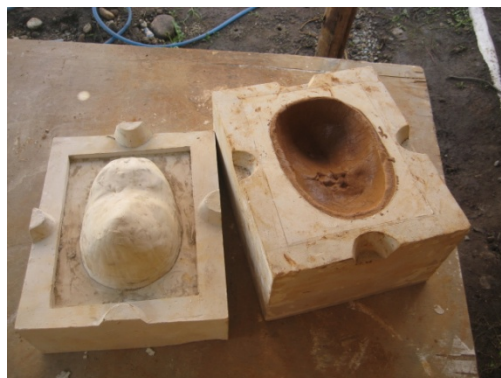
Ilustración 64: Se coloca la pieza hembra del molde sobre el tablero de la prensa, se coloca la pieza macho, se baja el grillete hasta que las piezas se junten, se levanta el grillete, se retira el molde, se separan las piezas y finalmente se retira el plástico.
