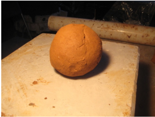
Ilustración 33: se pesan 400 gr. de arcilla, se amasa y se realiza una esfera.
