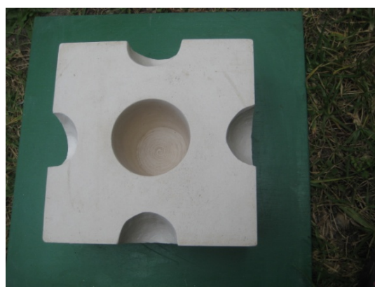
Ilustración 22: Se tallan cuatro llaves en cada lado de la pieza hembra.
