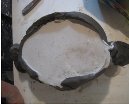
Ilustración 49: Se vierte la mezcla óptima yeso más agua.
