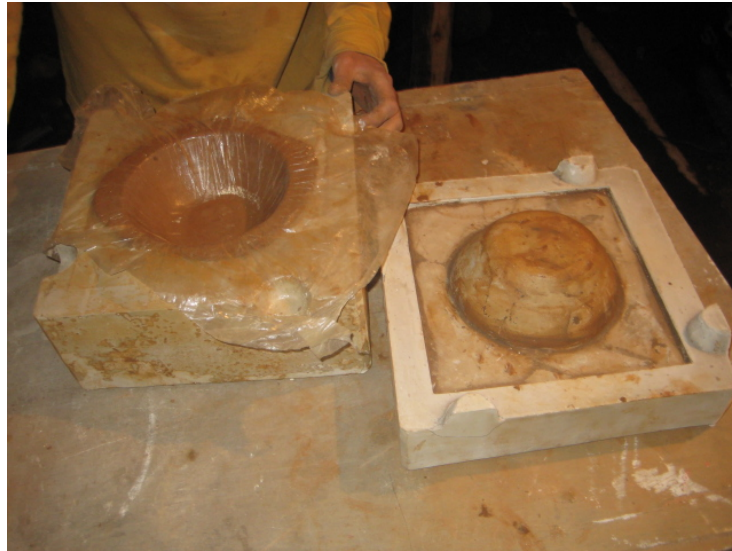
Ilustración 41: se levanta la pieza hembra.
