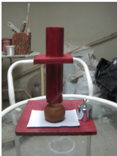
Ilustración 31: Guía de peso con esfera de arcilla.
