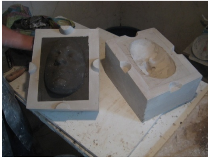
Ilustración 60: Se prosigue a separar las piezas macho y hembra.
