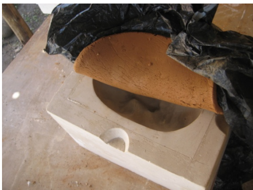
Ilustración 65: Se coloca la plancha de arcilla dentro de la pieza hembra
