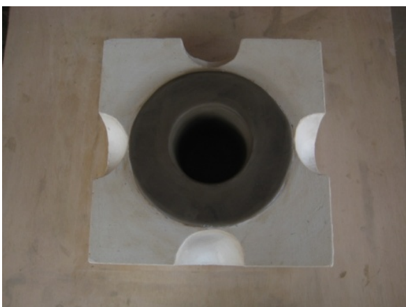
Ilustración 24: Realizando una plancha de arcilla de un espesor de 5mm se forma manualmente el contenedor utilizando la forma dada de la pieza hembra. Se realiza un anillo de 4 cm alrededor del espacio del contenedor. Este procedimiento es muy importante para que escape el exceso de arcilla en el momento en que se ejerce la presión entre las dos piezas del molde, formando el contenedor.
