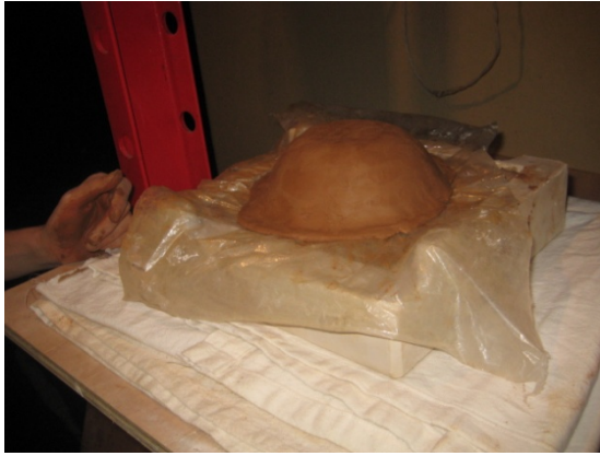
Ilustración 37: se coloca la plancha de arcilla sobre la pieza macho y se da forma.
