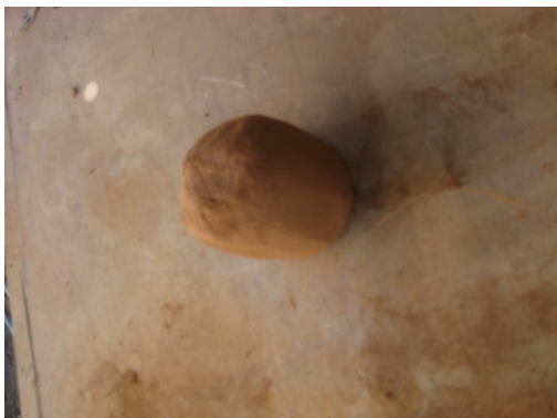
Ilustración 62: Se pesan 800gr. de la mezcla óptima, se amasa y se hace una espera.
