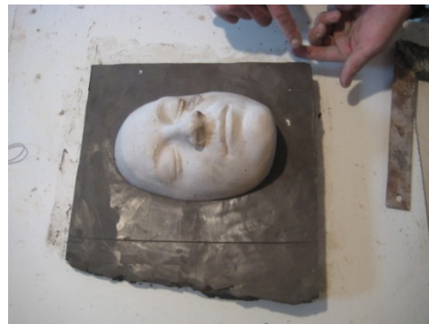
Ilustración 50: Se realiza una cama de arcilla alrededor de la matriz y luego se corta la cama dejando 5 cm a cada lado desde la matriz.
