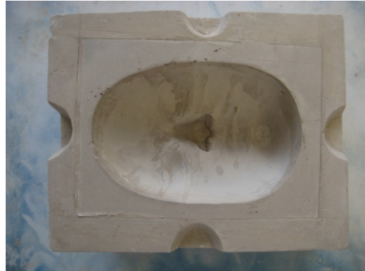
Ilustración 55: Se tallan 4 llaves una en cada lado de la pieza hembra
