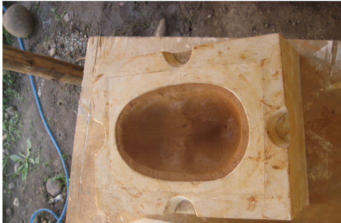
Ilustración 66: Se corta con un hilo el excedente de arcilla.
