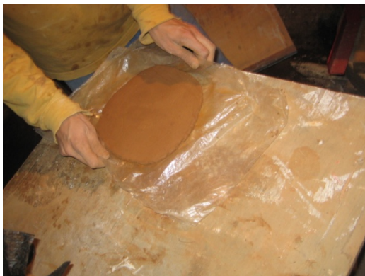
Ilustración 35: en un plástico se extiende el pastel con ayuda de un bolillo y se hace una plancha.
