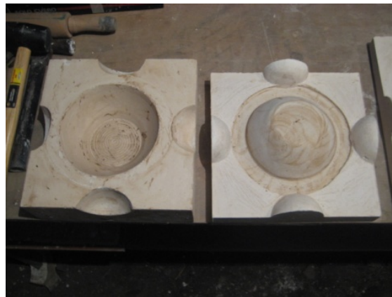
Ilustración 28: Se retira las planchas de arcilla y se deja a secar durante 8 días.
