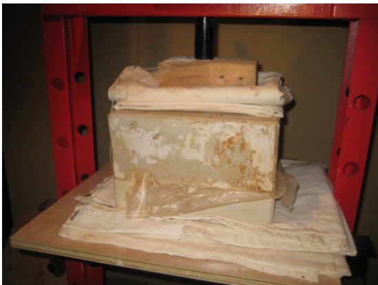
Ilustración 39: se baja el grillete de la prensa hasta que las dos piezas se junten.
