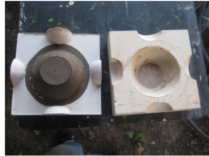
Ilustración 26: Luego se separan las piezas macho y hembra.
