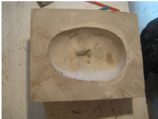
Ilustración 54: Se saca la matriz quedando lista la pieza hembra del molde.
