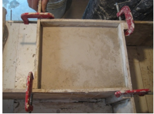
Ilustración 52: Se vierte la mezcla óptima yeso más agua.
