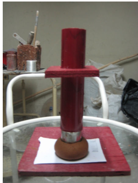
Ilustración 32: Acción de la pesa sobre la esfera de arcilla.
