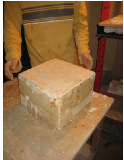
Ilustración 40: se levanta el grillete de la prensa y se retira el molde.
