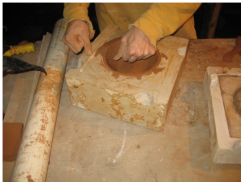
Ilustración 43: se retira el plástico y recortan con un hilo los excedentes.
