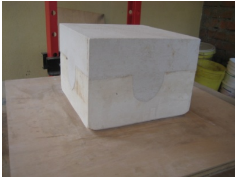
Ilustración 27: Se desarma las tablas de encofrado, se pulen los filos y la parte superior.
