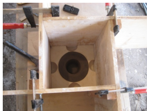
Ilustración 25: Se arma nuevamente las tablas de encofrado y se aísla con jabón las paredes como la pieza hembra. Luego, de igual manera, se vierte la mezcla óptima, agua-yeso más aglutinante.
