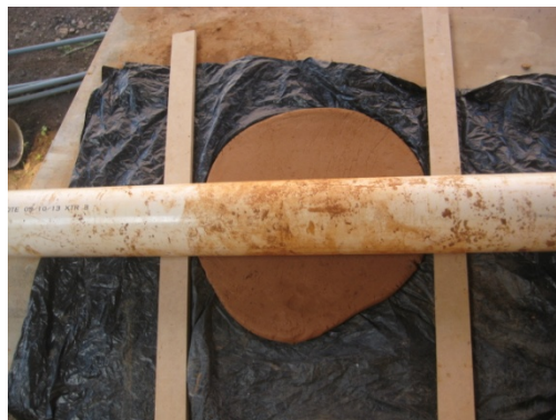
Ilustración 63: Se realiza un pastel y luego una plancha con la ayuda de un bolillo.
