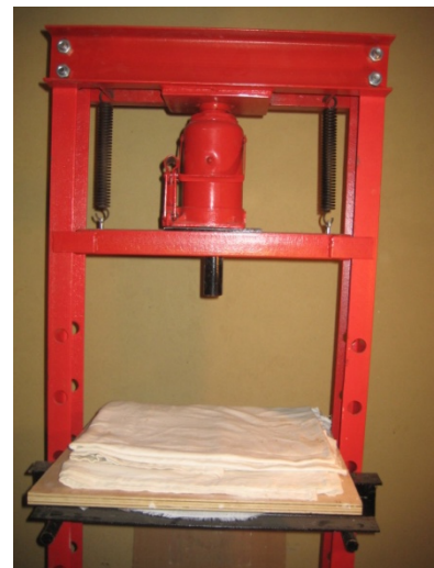
Ilustración 36: se coloca la pieza macho sobre el tablero de la prensa.
