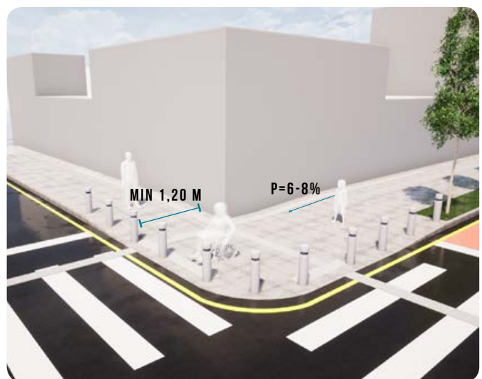
Rampa con abanico
