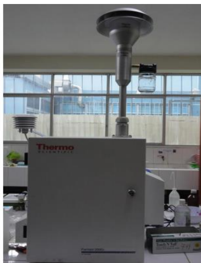
Equipo y pantalla de programación del equipo muestreador de bajo caudal Partisol 2000i del Centro de Estudios Ambientales
