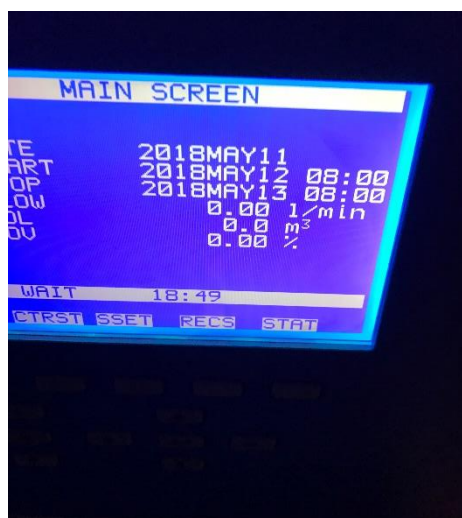
Equipo y pantalla de programación del equipo muestreador de bajo caudal Partisol 2000i del Centro de Estudios Ambientales
