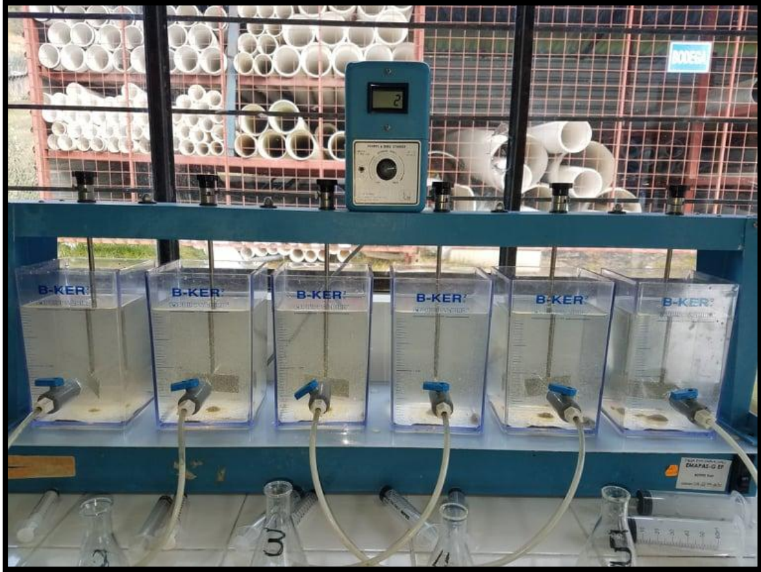
Ilustración 29. Ensayo de jarras No. 15 correspondiente al mes de agosto.
