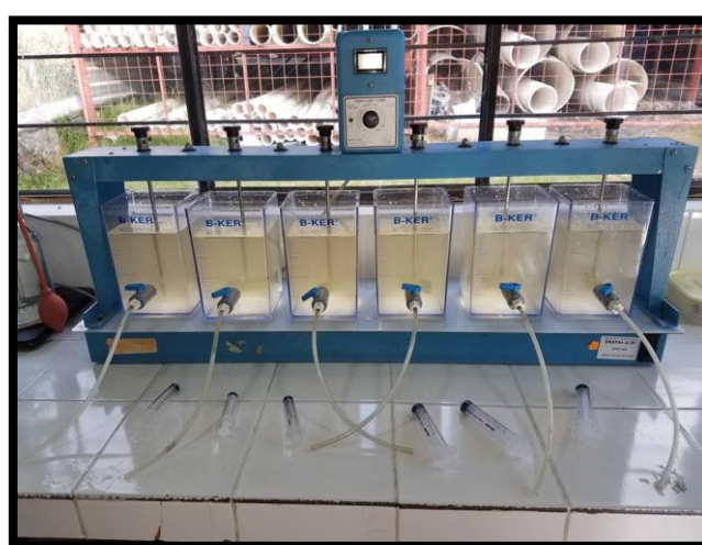
Ilustración 27. Equipo de prueba de jarras – Laboratorio de Planta de Tratamiento de Agua Potable Gualaceo (PTAP-G)
