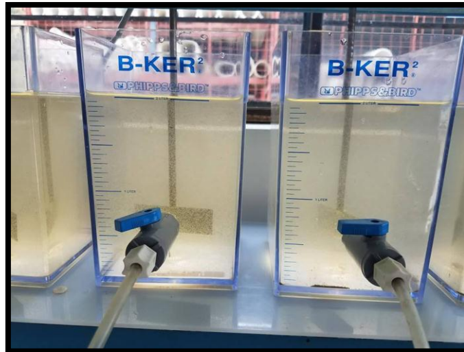
Ilustración 28. Flóculos formados en rangos superiores a 7,11 unidades de pH Fuente: Autor
