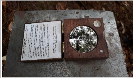
Imagen 24. Medición del porcentaje de sombra en los bosques con el uso del densiometro esférico
