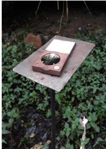
Imagen 3. Ubicación y nivelación del densiometro esférico en el campo. Fuente: Grupo de trabajo.
