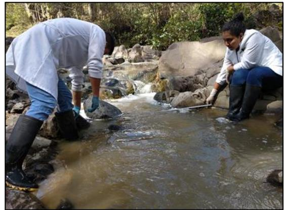
*Ilustración 9. Medición del ancho del río, punto 3.*
