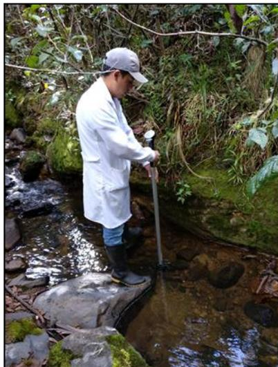
Ilustración 16. Medición de caudal con molinete Global Water.
