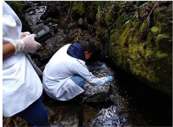
*Ilustración 5. Medición con Multiparámetro HACH, punto 1.*
