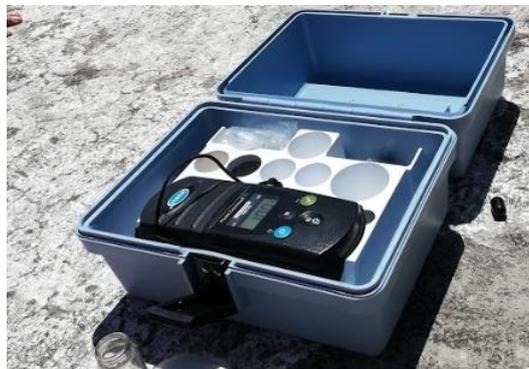
Ilustración 45. Dispositivo para la medición de cloro residual en buen estado.
