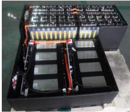
Figura 2.5. Batería de Litio-ferrofosfato para autobuses eléctricos [1].
