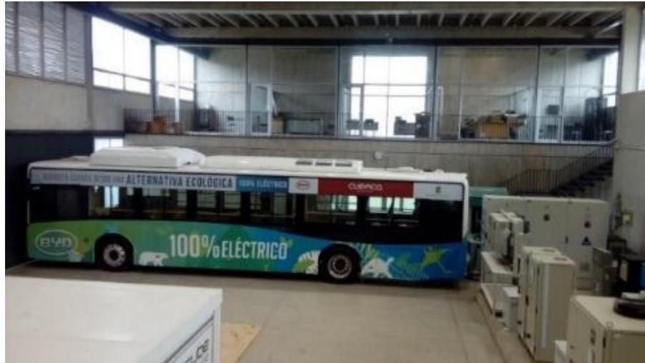
Figura 2.2. Autobús 100% eléctrico modelo K9, fabricante BYD [31].
