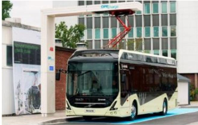
*Figura 2.20. Cargador tipo pantógrafo [3].*
