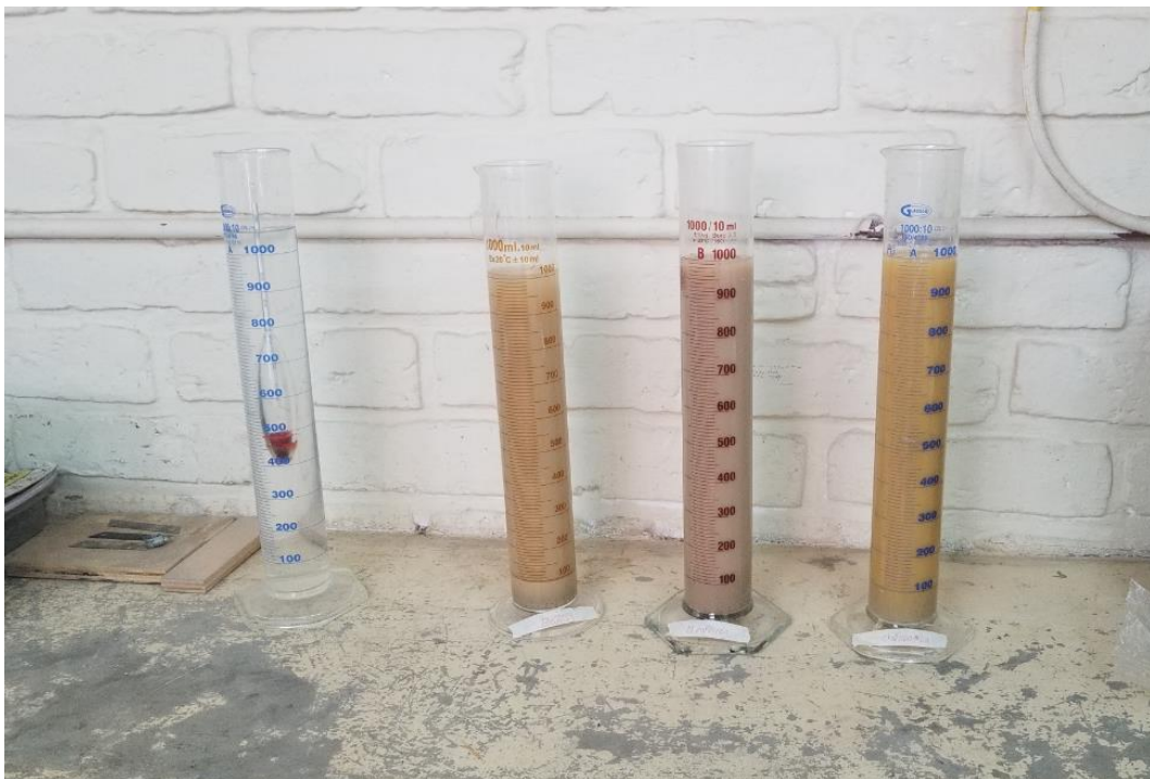
Ilustración 21. Probetas con muestras de suelo y probeta con defloculante.
