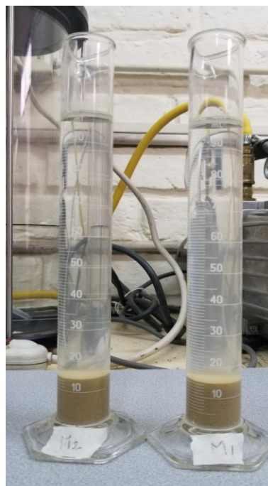
Ilustración 26. Probetas con muestra de suelo en agua destilada.
