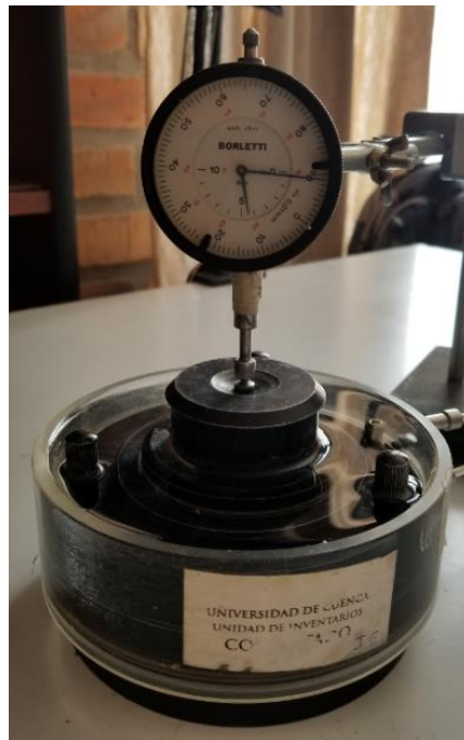
Ilustración 22. Ensayo de expansión libre.
