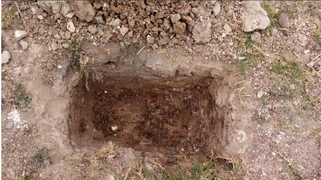
Ilustración 19. Pozos para extracción de muestras.
