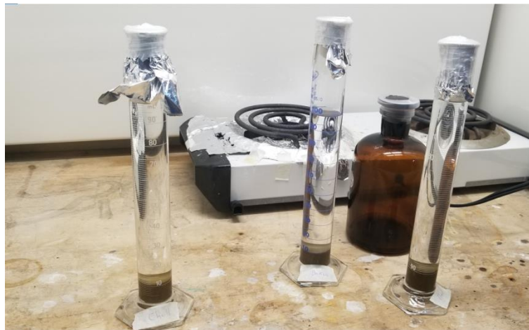
Ilustración 25. Probetas con muestra de suelo en tetracloruro de carbono.
