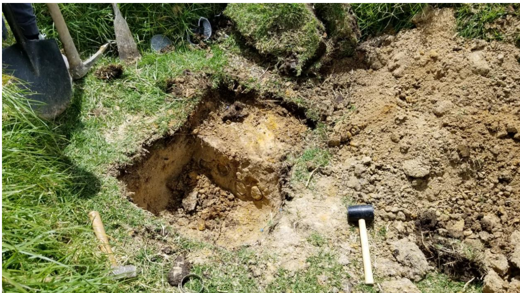
Ilustración 20. Inserción de anillos metálicos para obtención de muestras inalteradas en el sector de Baños.
