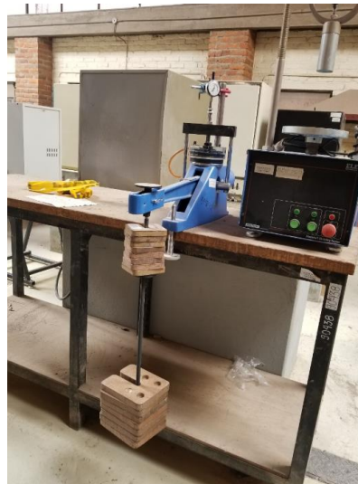
Ilustración 23. Ensayo de presión de expansión.
