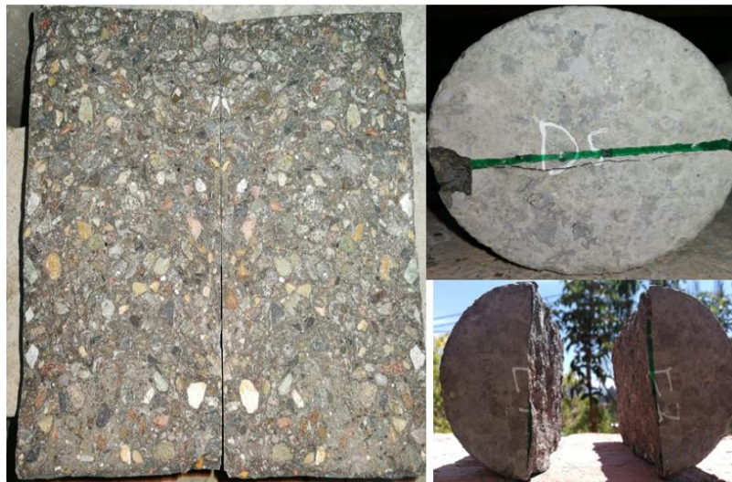
Ilustración 11 Modo de falla del ensayo a tracción.
