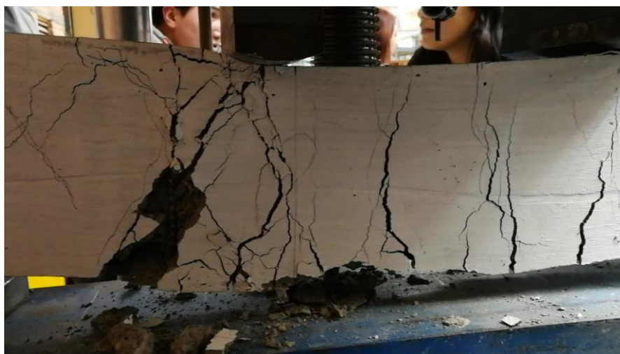
Ilustración 17 Resultado del ensayo a flexión con hormigón de 450 Kg/cm 2
