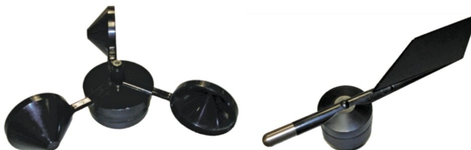
Figura 2-9 Anemómetro de cazoletas (izquierda) y veleta (derecha)
