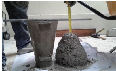
Figura 15. Ensayo de trabajabilidad
