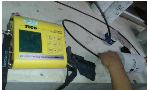
Figura 19. Ensayo del ultrasonido
