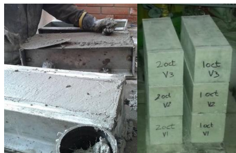
Figura 14. Especímenes prismáticos elaborados.
