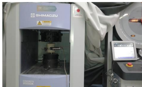
Figura 18. Ensayo de doble punzonamiento.
