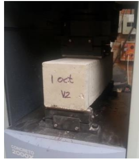
Figura 16 Ensayo a flexión de vigas
