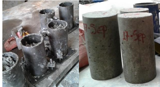
Figura 13. Especímenes cilíndricos elaborados.
