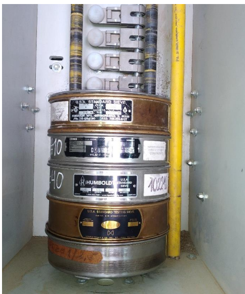
Figura 21: Tamizado suelo para determinación de granulometría ASTM D422-63.
