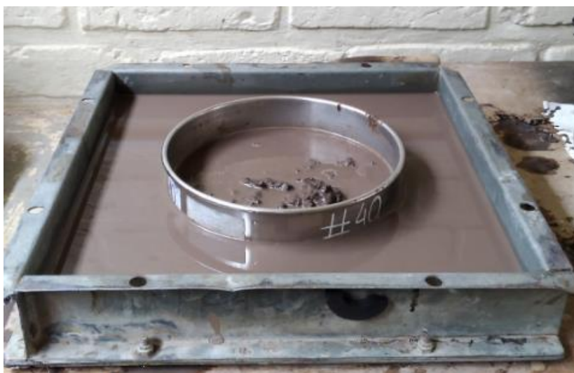
Figura 24: Proceso de lavado del suelo a través del tamiz #40.
