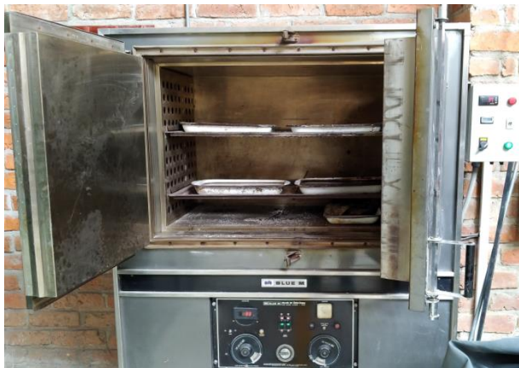
Figura 25: Eliminación del exceso de agua del suelo de acuerdo a ASTM D4318-00.
