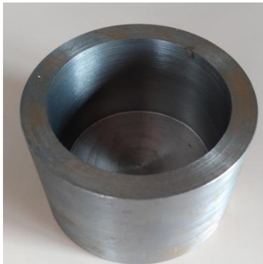
Figura 12: Copa metálica para ensayos de Cono de Penetración.
