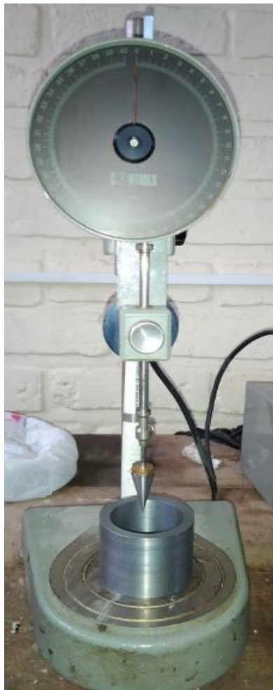
Figura 11: Aparato de penetración en materiales bituminosos disponible en el Laboratorio de Geotecnia y Materiales de la Universidad de Cuenca.
