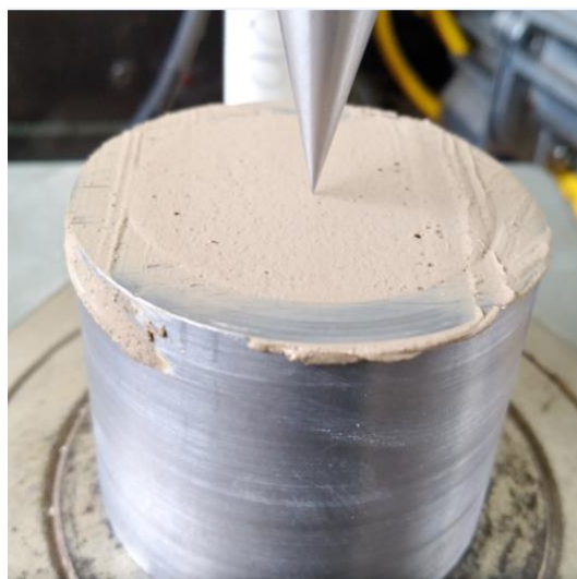
Figura 31: Cono de Penetración apenas en contacto con el suelo.
