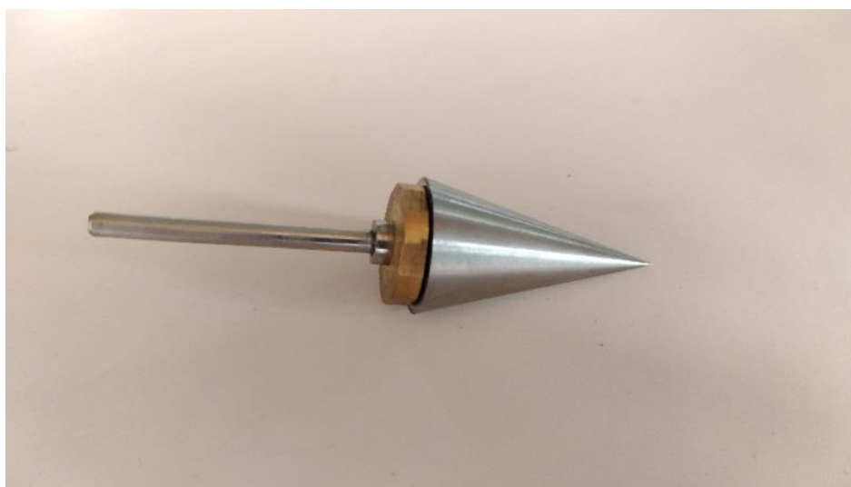
Figura 34: Cono de Penetración construido para este estudio.
