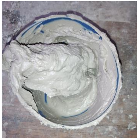
Figura 26: Mezclado y homogenización del suelo según las normas ASTM D4318-00 y BS 1377-2:1990.
