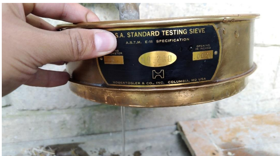
Figura 20: Lavado de suelo de acuerdo a la norma ASTM C117-95.
