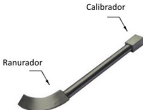
Figura 9: Ranurador disponible en el Laboratorio de Geotecnia y Suelos de la Universidad de Cuenca.
