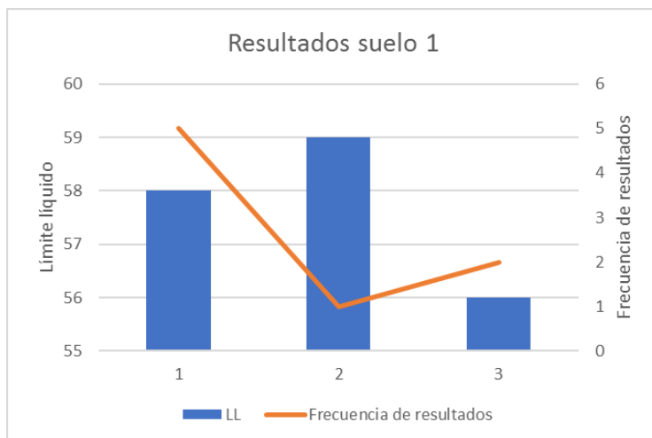
Figura 47: Resultados de ensayos y frecuencia del suelo 1 por método de la Cono de Penetración.
