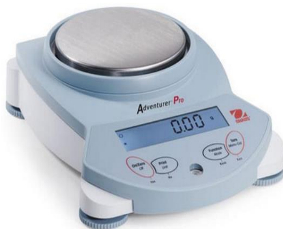
Figura 16: Balanza OHAUS con resolución de 0.1 g.
