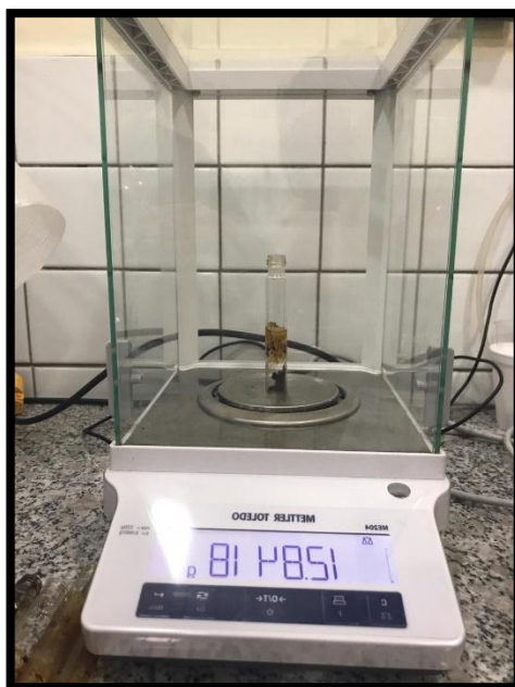
Ilustración 40. Fotografías del proceso para la cuantificación de biomasa por el método de peso seco en el laboratorio de operaciones unitarias, tecnológico de la Universidad de Cuenca
