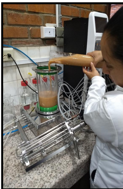
Ilustración 38. Llenado del mucílago en el reactor Batch
