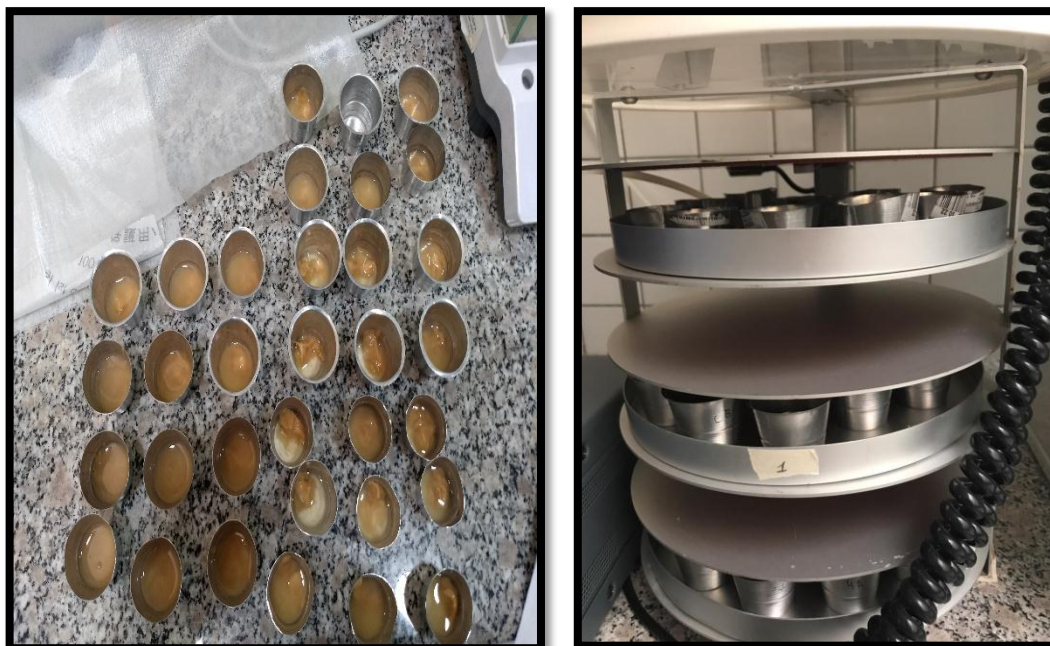
Ilustración 41. Cuantificación de biomasa por el método de liofilización, laboratorio de humidificación y secado, tecnológico de la Universidad de Cuenca
