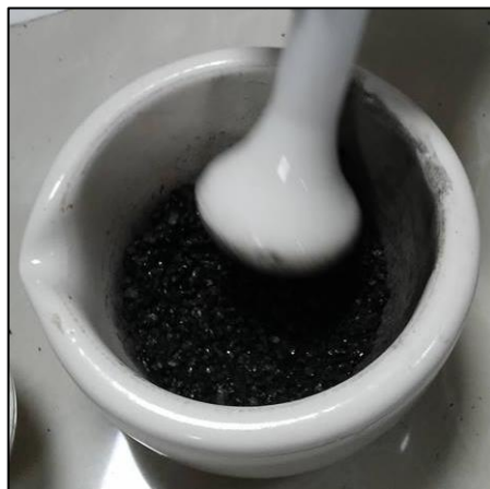
Ilustración 37. Pulverizado de carbón activado en mortero
