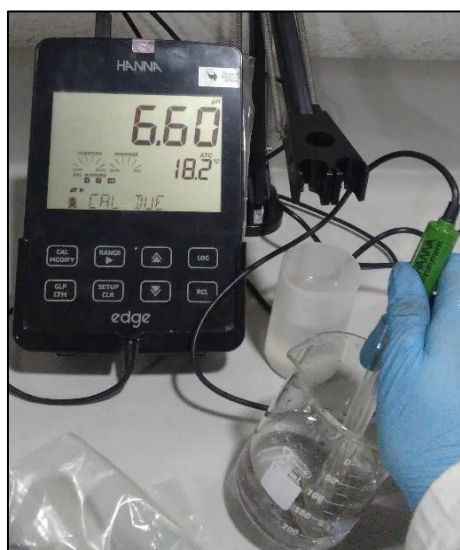
Ilustración 34. pH final obtenido durante el proceso de lavado del carbón activado
