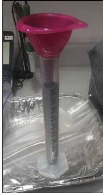
Ilustración 42. Muestra de carbón activado en la probeta para Determinación de Densidad Aparente
