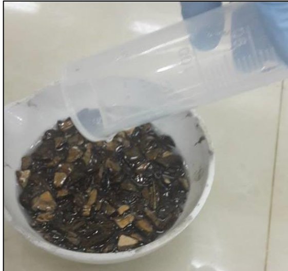
Ilustración 12. Activación química con \text{H}_3\text{PO}_4
