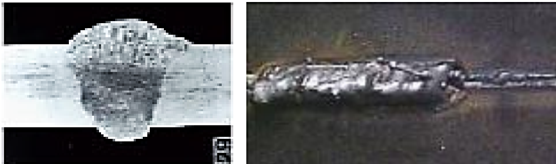
Figura 21. Exceso de penetración Fuente: (METALFUSION, 2017)
