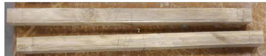
Imagen 3.56: Probeta de laminados de guadúa. Fuente: Cabrera, César. Archivo personal.
