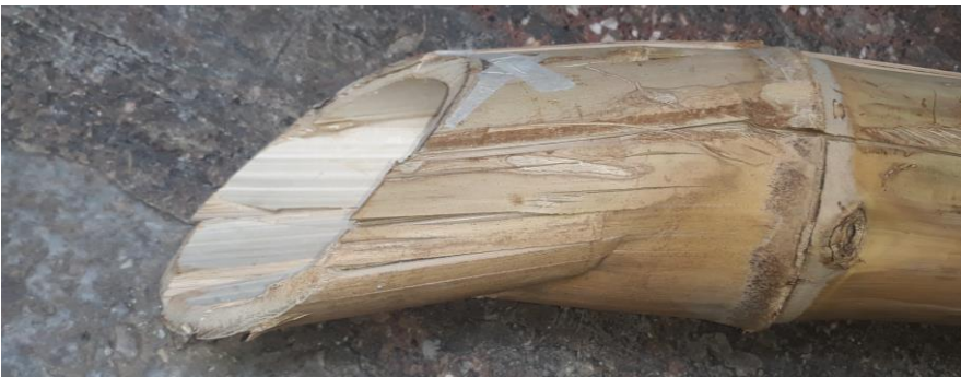
Imagen 3.27: Aplastamiento en el punto de aplicación de la carga. Fuente: Cabrera, César. Archivo personal.
