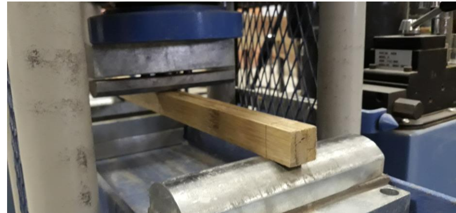
Imagen 3.66: Ensayos de flexión con cargas paralelas a las fibras. Fuente: Cabrera, César. Archivo personal.
