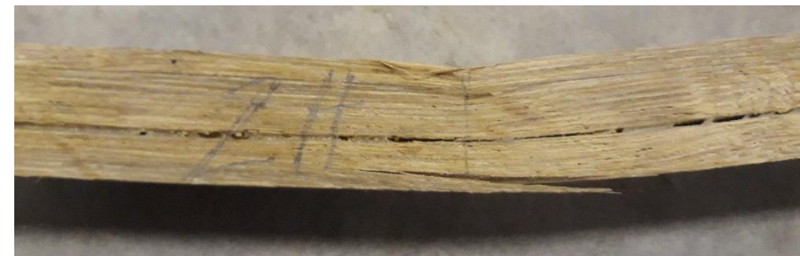
Imagen 3.69: Fracturas en probetas con cargas perpendicular a las fibras.
