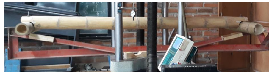
Imagen 3.43: Soporte con viga metálica. Fuente: Cabrera, César. Archivo personal.
