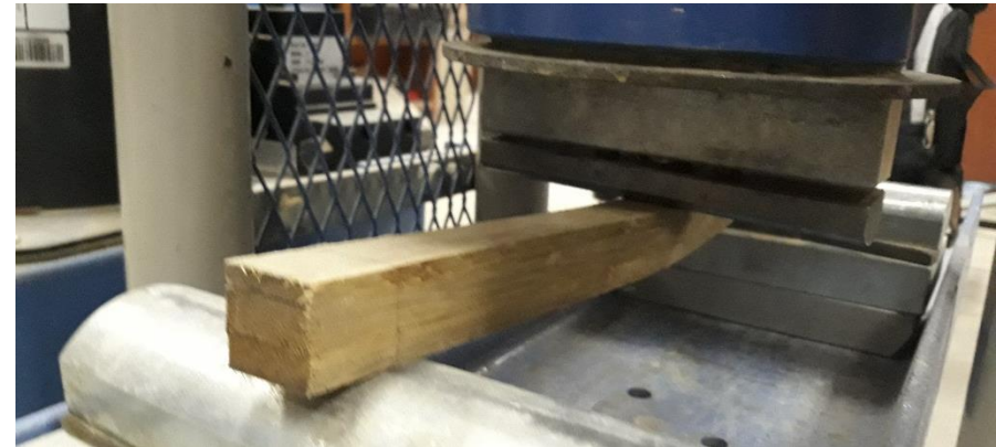
Imagen 3.65: Ensayos de flexión con cargas perpendiculares a las fibras. Fuente: Cabrera, César. Archivo personal.
