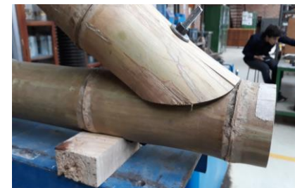
Imagen 3.11: Soportes curvos de madera. Fuente: Cabrera, César. Archivo personal.
