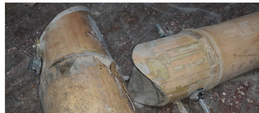
Imagen 3.34: Fallo del perno tensor. Fuente: Cabrera, César. Archivo personal.
