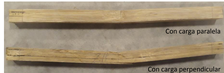
Imagen 3.67: Deformación en probetas de laminados de guadua a flexión.
