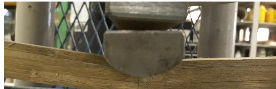
Imagen 3.63: Adaptador para aplicar carga. Fuente: Cabrera, César. Archivo personal.
