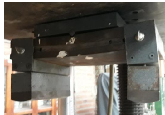
Imagen 3.42: Adaptador para aplicar carga en 2 puntos. Fuente: Cabrera, César. Archivo personal.
