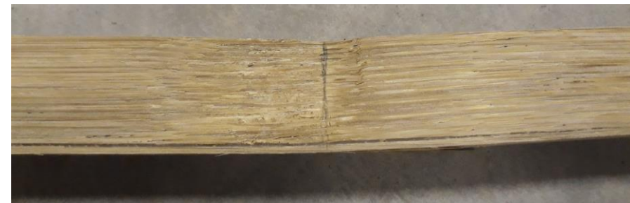
Imagen 3.68: Fracturas en probetas con cargas paralela a las fibras.
