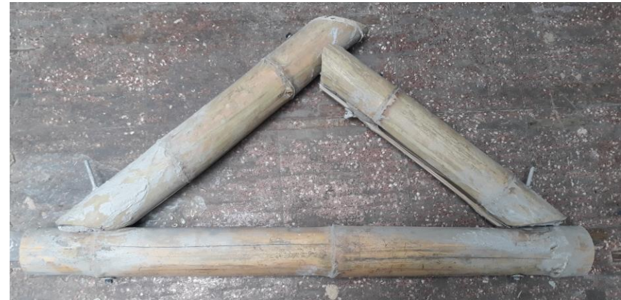
Imagen 3.33: Estructura con mortero de refuerzo luego de ser ensayada. Fuente: Cabrera, César. Archivo personal.
