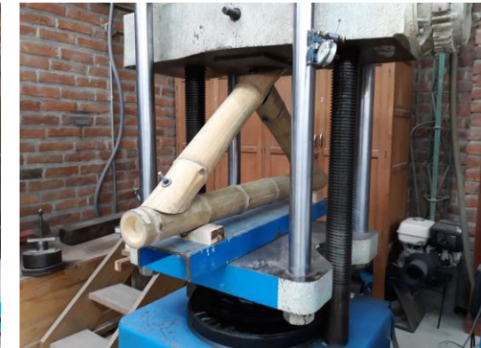
Imagen 3.9: Prensa universal del Laboratorio de Ingeniería. Fuente: Cabrera, César. Archivo personal.
