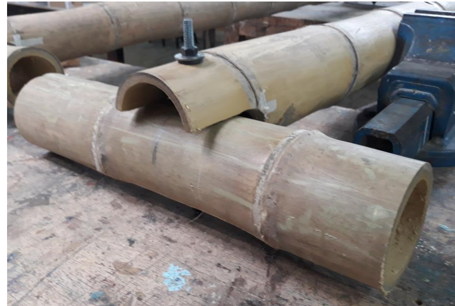
Imagen 3.46: Unión por superposición empernada con corte a media caña. Fuente: Cabrera, César. Archivo personal.
