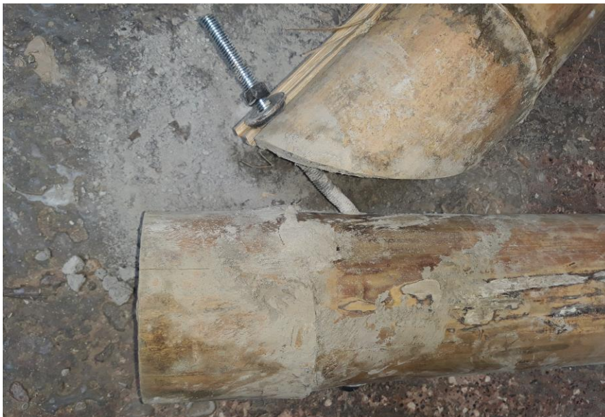
Imagen 3.36: Deformación en el perno de la unión inferior. Fuente: Cabrera, César. Archivo personal.
