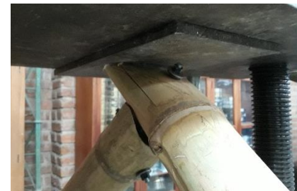
Imagen 3.10: Adaptador para aplicar carga. Fuente: Cabrera, César. Archivo personal.
