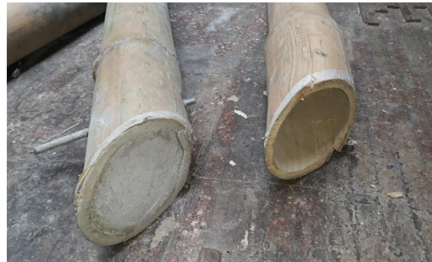
Imagen 3.38: Diferencia de comportamiento frente a esfuerzos de compresión perpendicular. Fuente: Cabrera, César. Archivo personal.
