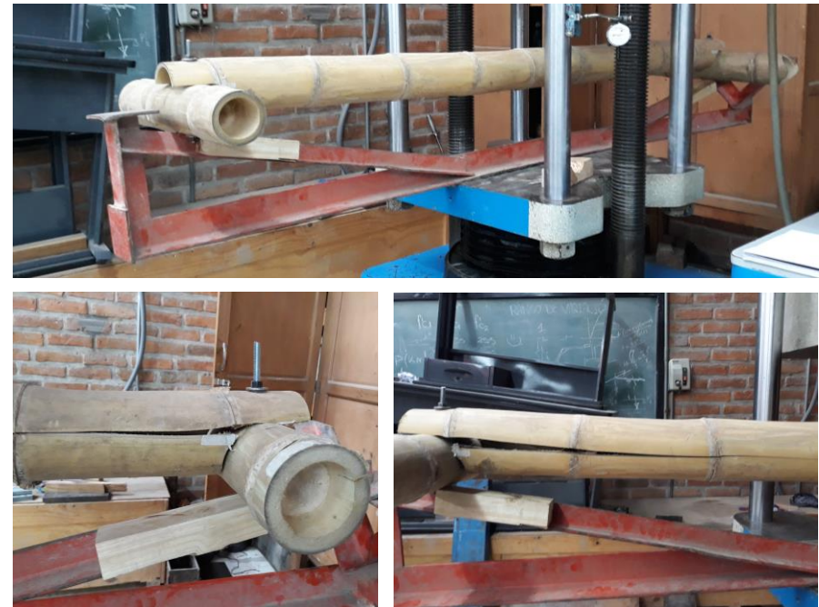
Imagen 3.53: Falla en la conexión emperrada por superposición en la viga del nivel +3,08. Fuente: Cabrera, César. Archivo personal
