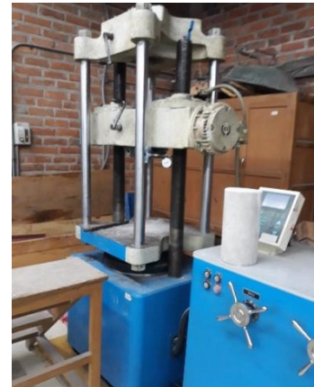
Imagen 3.9: Prensa universal del Laboratorio de Ingeniería. Fuente: Cabrera, César. Archivo personal.
