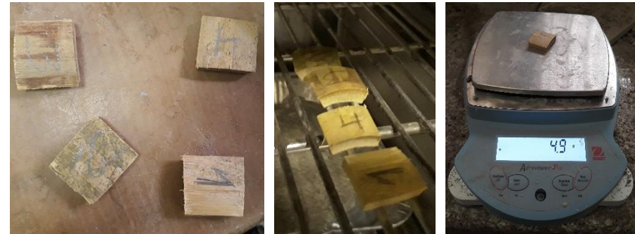
Imagen 3.5: Ensayos de contenido de humedad de la caña.
