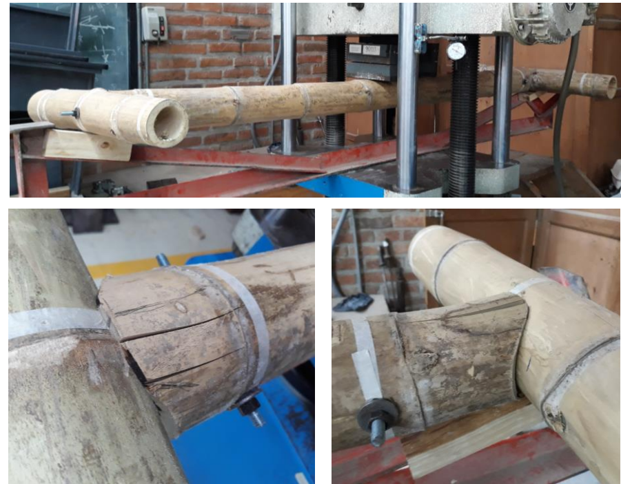
Imagen 3.50: Falla en la conexión emperrada a boca de pez en la viga del nivel +0,84. Fuente: Cabrera, César. Archivo personal
