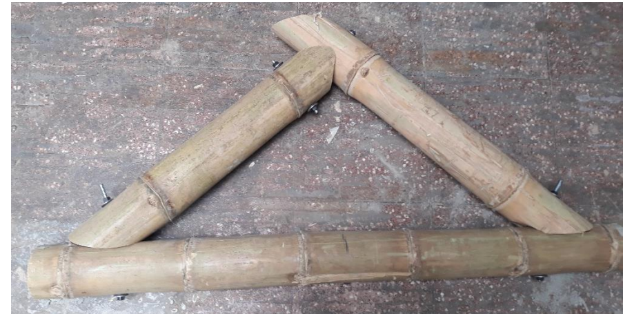
Imagen 3.26: Estructura con conexiones empernadas luego de ser ensayada. Fuente: Cabrera, César. Archivo personal.
