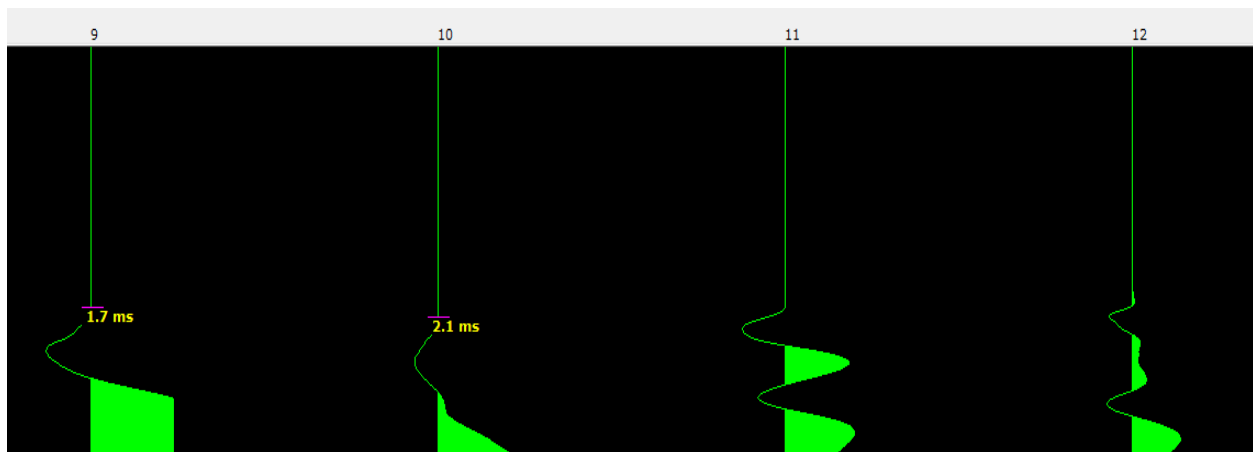
Figura 4.9. Tiempos de ondas S registrados en el equipo sísmico.
