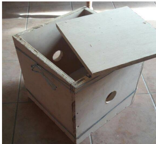
Figura 4.5. Molde de madera reforzada, utilizada para el ensayo dinámico del suelo.
