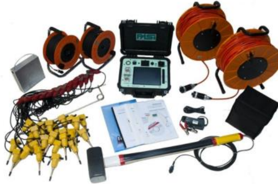
Figura 4.6. Equipo sísmico PASI modelo 16SG24-N (Avilés & Barzallo, 2016).
