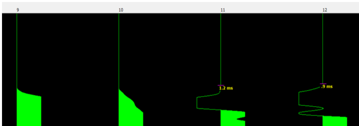
Figura 4.8. Tiempos de ondas P registrados en el equipo sísmico.
