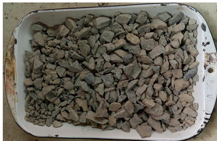
Ilustración 8 Agregado Grueso triturado o Ripio.
