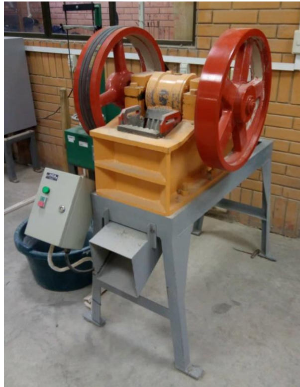
Ilustración 1 Trituradora de mandíbulas de la Universidad de Cuenca.
