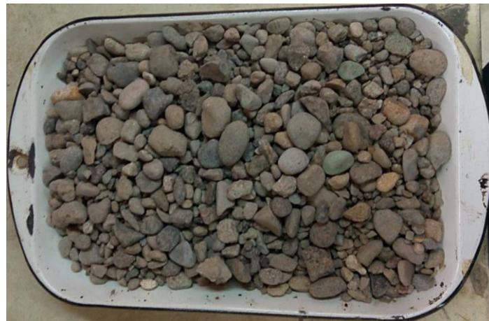
Ilustración 7 Agregado Grueso de río o Grava.
