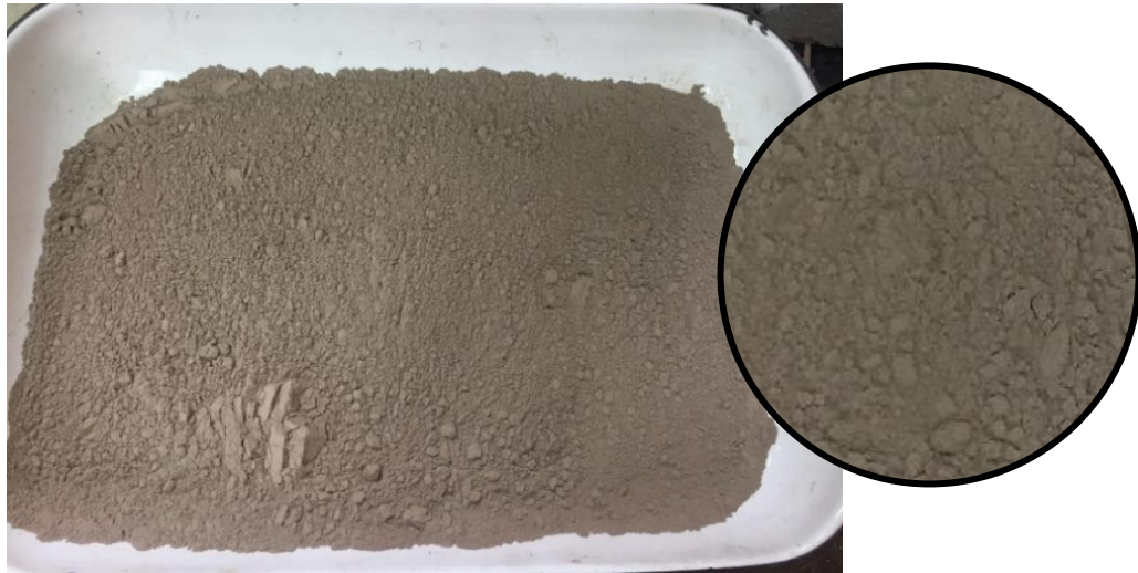
Ilustración 12 Ceniza que pasó el tamiz N°200 y se retuvo en el fondo.
