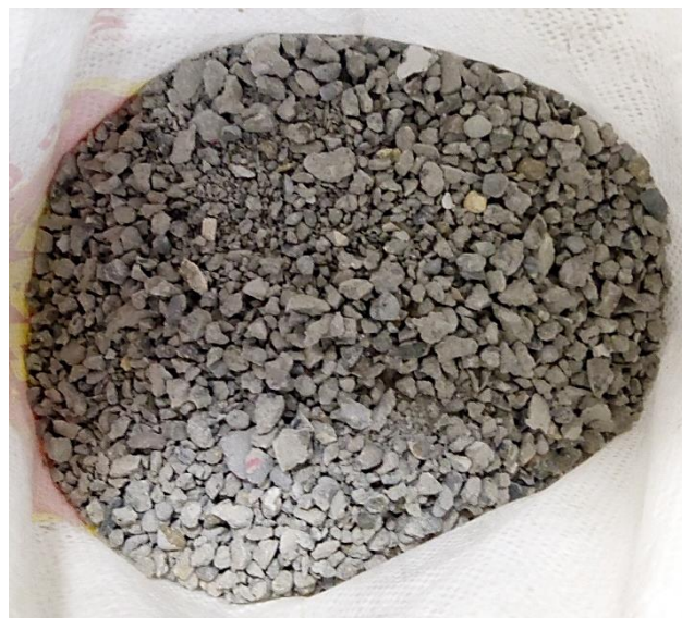
Ilustración 11 Hormigón reciclado después del proceso de triturado.
