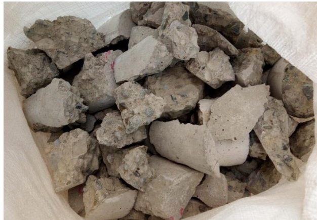
Ilustración 10 Hormigón reciclado antes del proceso de triturado.
