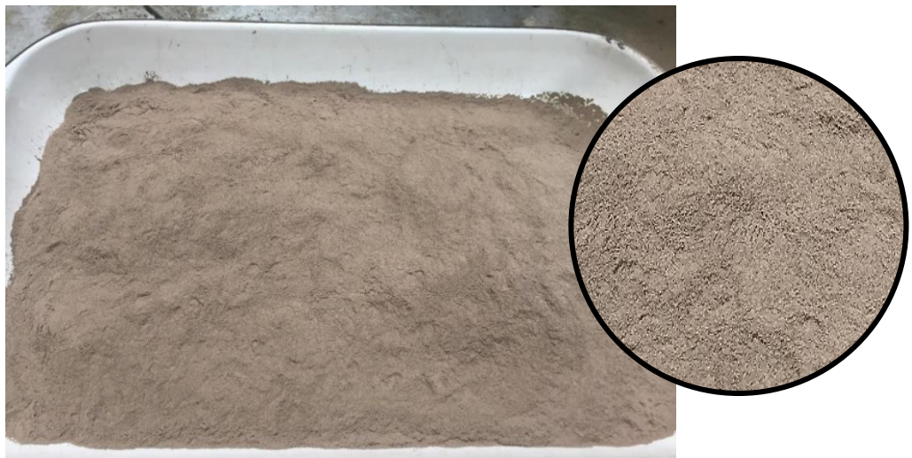
Ilustración 13 Ceniza que pasó el tamiz N°100 y se retuvo tanto en el tamiz N°200 como en el fondo.
