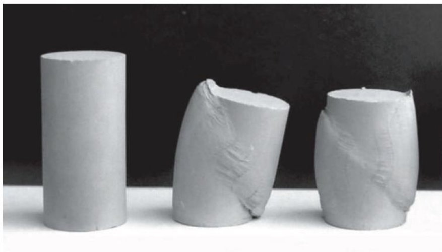
Figura 1.3: Localización de la deformación que se produce para cargas de compresión en muestras de arcilla limosa cilíndrica
