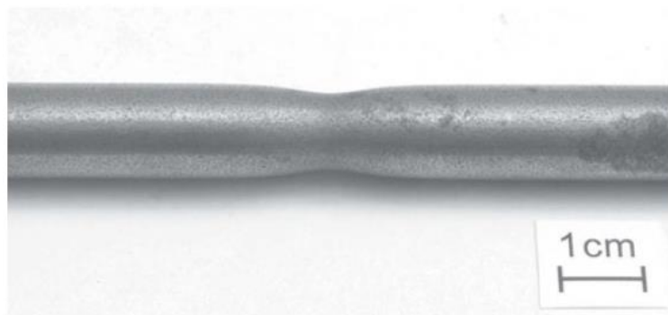
Figura 1.1: Localización de deformación que se produce para cargas de tracción en muestras de acero con bajo contenido de carbono.
