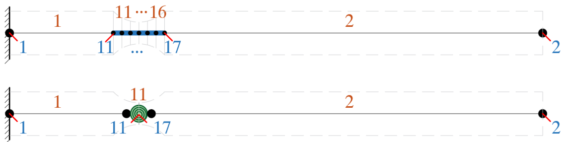
Figura 30: Esquema de la modelación del experimento viga en voladizo
